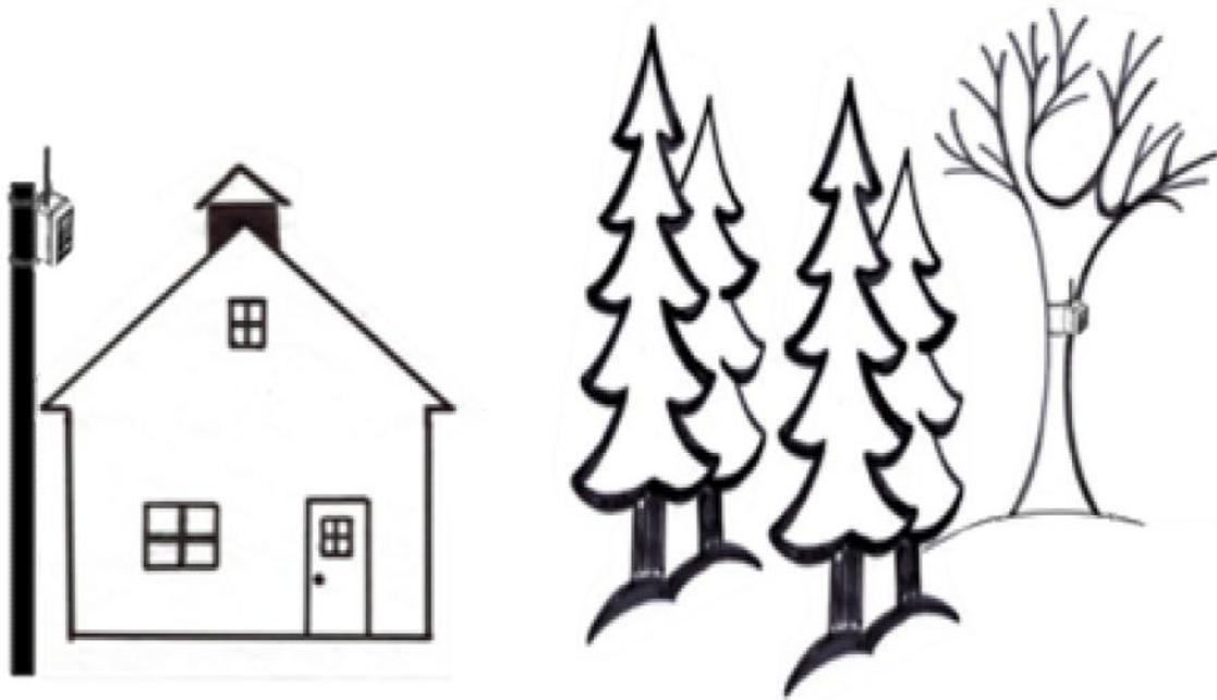
Un ou plusieurs répéteurs seront peut-être nécessaires pour maintenir une communication stable à travers les conifères ou une forêt dense. Si vous installez un module à travers les conifères, assurez-vous qu'il y a un dégagement suffisant pour le panneau solaire. Autrement, vous risquez d'utiliser la batterie primaire plus rapidement.
