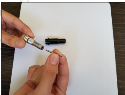
Figura 8.2 Después de desenroscar la porta navajas.
