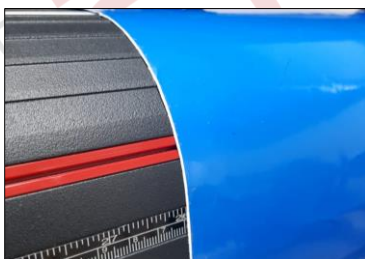
Figura 7.2 Alineación del vinil con la cintra métrica.
