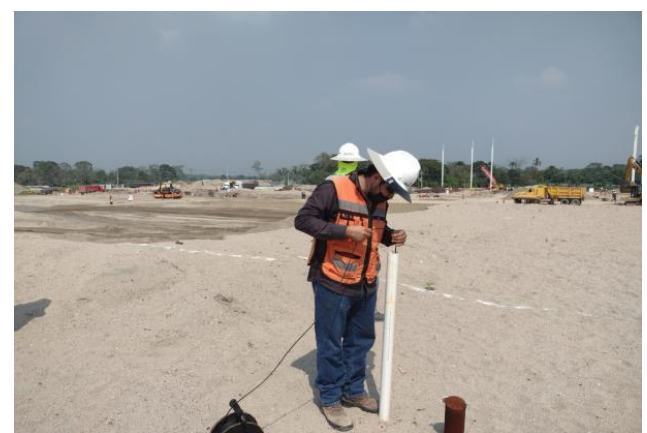
Figure 12. Tomas de lectura en campo en la estación piezométrica.
