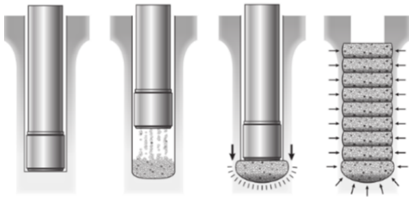
Figura 9. Secuencia de construcción de las Pilas de Agregado Compactado por el método de desplazamiento.
