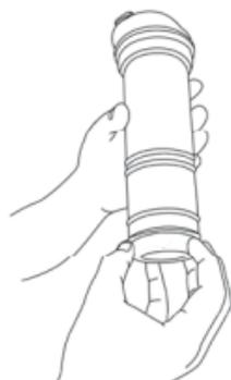
7. Desenrosque e separe o filtro e a tampa do êmbolo, girando no sentido anti-horário para desmontar.
