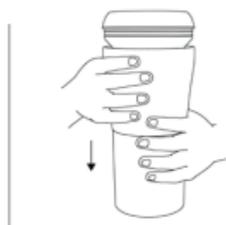
2. Segure o copo externo apoiado na mesa e pressione para baixo. O copo externo desce e se solta.
