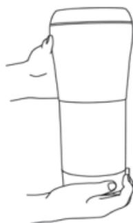
Verifique se o anel de vedação do êmbolo está bem encaixado e alinhado. Para a Pressca funcionar corretamente e evitar vazamentos, certifique-se de que a base do corpo, a tampa e o filtro estejam bem rosqueados.
