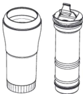
11. Guarde o êmbolo e o corpo separadamente. Após lavar e secar as peças, o anel de vedação tende a fixar-se na parede do êmbolo, dificultando a retirada do mesmo.
