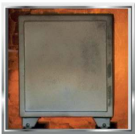
ทดสอบเผาไหม้ตู้ เป็นเวลา 2 ชั่วโมง Place the safe in a furnace for 2 hours
