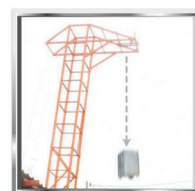
ตู้ยังคงแข็งแรงแม้ตก จากความสูง ระดับ 4 เมตร Lifted up at 4 meters high and performed drop test
