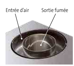
Sortie concentrique Ø 80 / 125 mm
