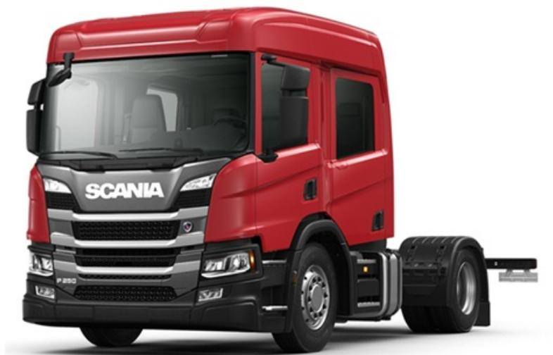
La cabina equipaggio CP28N accoglie fino a sei persone. L'area passeggeri può essere equipaggiata con una panca o con sedili per un massimo di quattro persone. La cabina è predisposta con punti di fissaggio per attrezzatura specifica.
