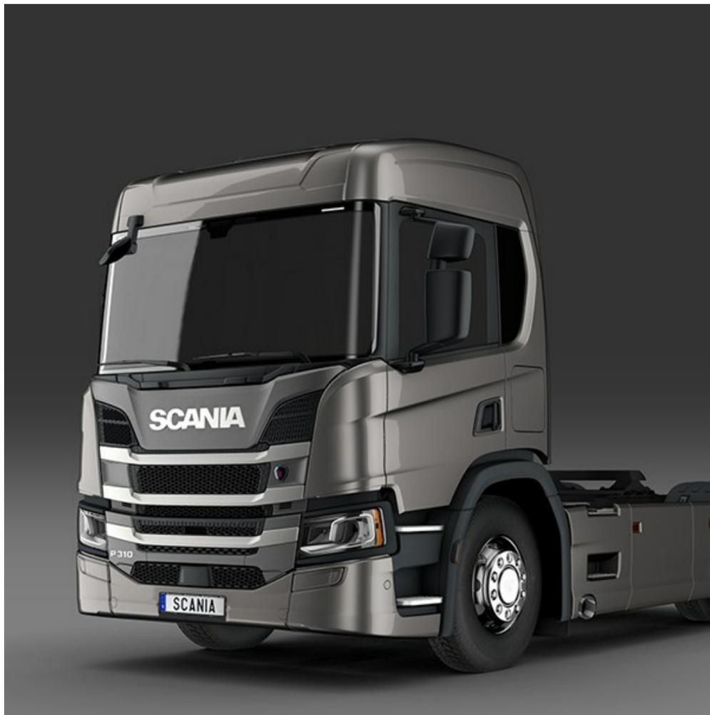
La cabina diurna della serie P con altezza del tetto normale è dotata di due gradini di accesso che permettono di salire e scendere agevolmente dalla cabina.
