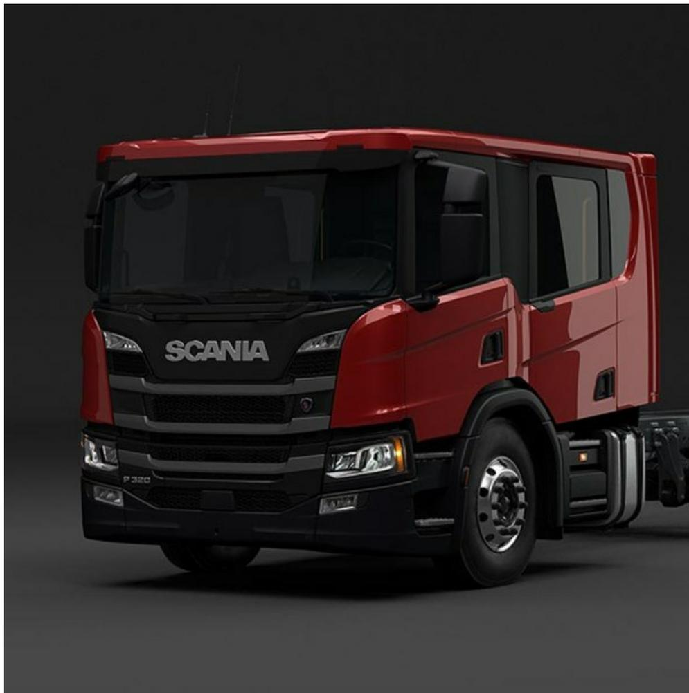
La cabina doppia lunga della serie P è dotata di spazio per un massimo di sei persone. L'area passeggeri può essere provvista di una panca o con sedili per un massimo di quattro persone. La cabina è predisposta con punti di fissaggio per attrezzatura specifica.
