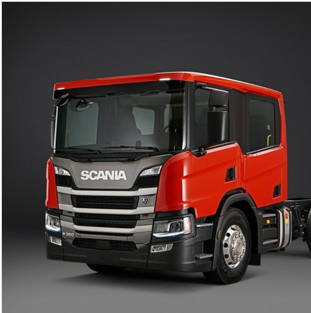
La cabina doppia corta della serie P accoglie fino a sei persone. L'area passeggeri può essere equipaggiata con una panca o con sedili per un massimo di quattro persone. La cabina è predisposta con punti di fissaggio per attrezzatura specifica.
