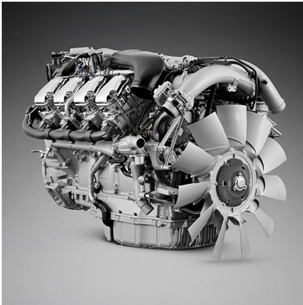
Motore diesel V8 dotato di sistema di iniezione XPI di Scania, 4 valvole per cilindro, turbocompressore a geometria fissa (turbocompressore), intercooler e sistema SCR sviluppato internamente da Scania.
