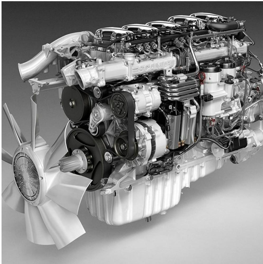
Motore diesel a 5 cilindri dritto dotato di sistema di iniezione XPI di Scania con iniettori di unità, 4 valvole per cilindro, turbocompressore a geometria fissa (FGT), intercooler e sistema SCR sviluppato internamente da Scania.
