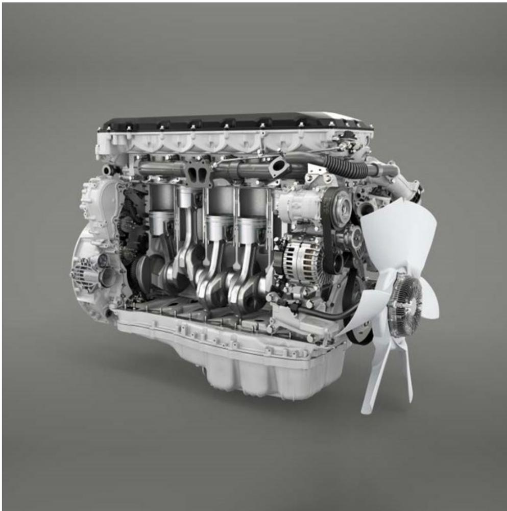
Motore diesel a 6 cilindri in linea SUPER con doppio albero a camme in testa, 4 valvole per cilindro, turbocompressore a geometria fissa (FGT) e sistema proprietario Scania di post-trattamento dei gas di scarico con Twin-SCR.
