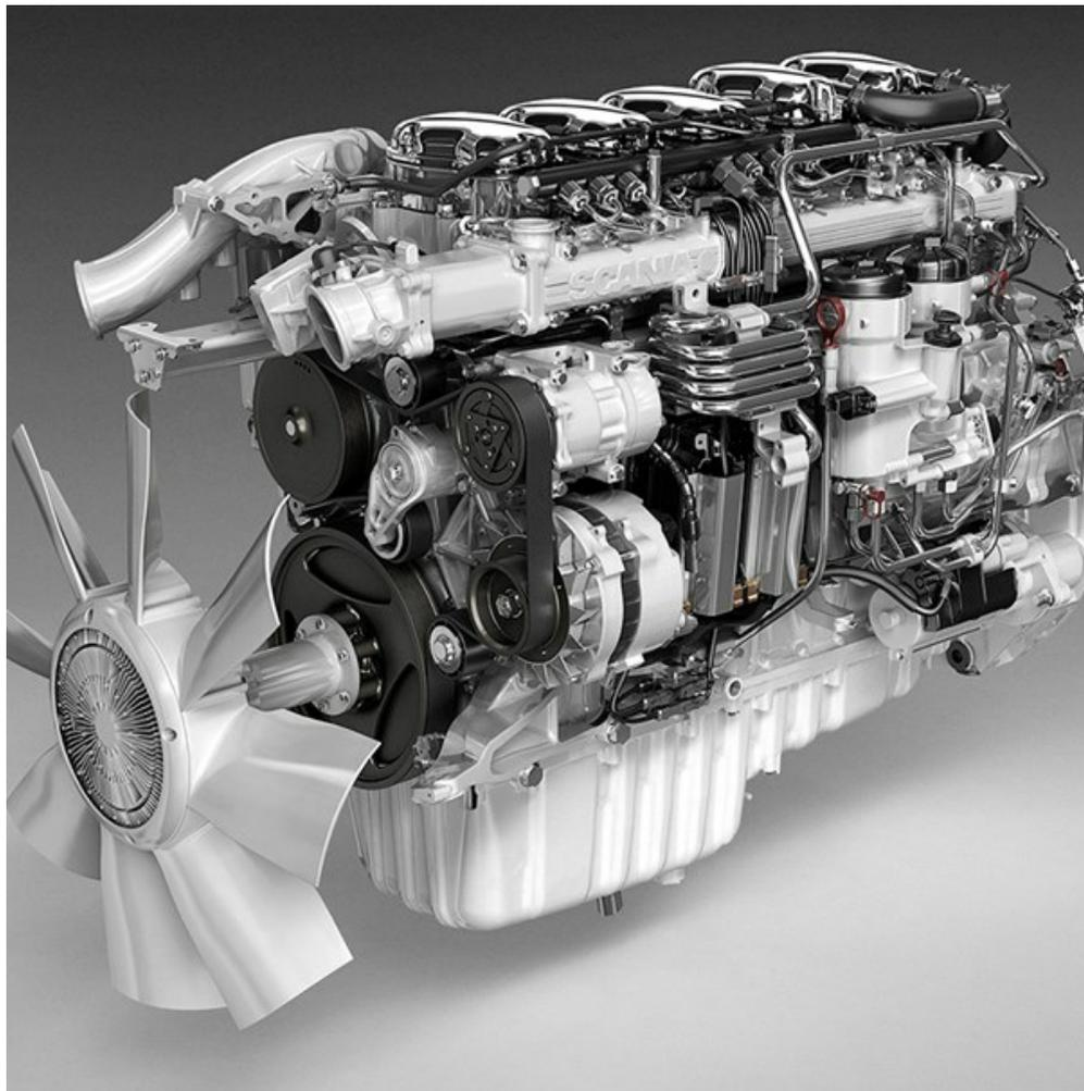
Motore in linea diesel a 5 cilindri dotato di sistema di iniezione XPI di Scania, 4 valvole per cilindro, turbocompressore a geometria fissa (turbocompressore), intercooler e sistema SCR sviluppato internamente da Scania.
