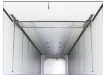
Elemento sandwich dello spessore di 85 millimetri con nucleo isolante
