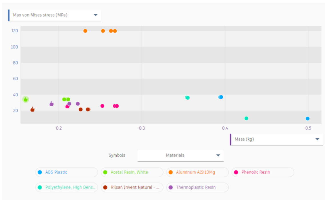
Resultados de diseño generativo Masa frente a Energía de distorsión
