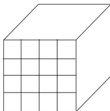
1. À partir du quadrillage de la face frontale, on peut, sans faire aucune mesure, quadriller les autres faces.
