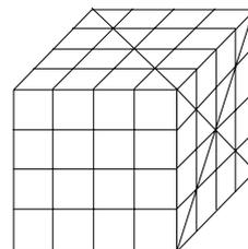
6. On vérifie que les diagonales de la face de droite passent bien par les nœuds du quadrillage.
