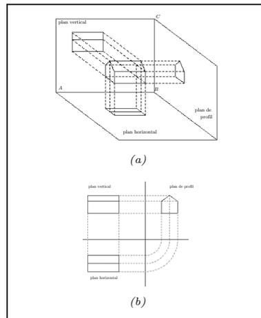
Ces explications permettent entre autres de reconnaître que sur la projection verticale de la maison, le toit est représenté par un rectangle et non par un trapèze (comme sur la figure 11 à la page suivante). Cela conduit aussi à accepter, un peu plus tard au cours de l'activité, que la vue verticale du cône (fiche 11h) se présente comme un triangle, et non comme sur la figure 12.
