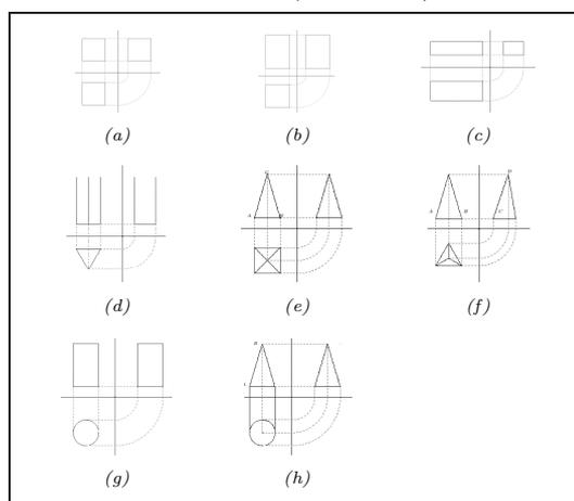
Ils construisent alors, en bristol, les solides les plus simples, à savoir le cube, le parallélépipède, les prismes et le cylindre. Ce sont ceux dont les dimensions sont faciles à relever en vraie grandeur sur les projections (voir fiche 11 à la page 211.) Il va de soi que les projections doivent constituer à ce stade du travail la seule source de renseignement. En particulier les solides eux-mêmes ne sont pas à ce moment disponibles aux élèves.
