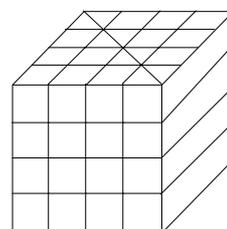
4. On utilise les points de division de la diagonale pour tracer un second réseau de parallèles sur la face supérieure.
