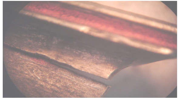
Figura 6 Fisura en pie de álabe de estator
