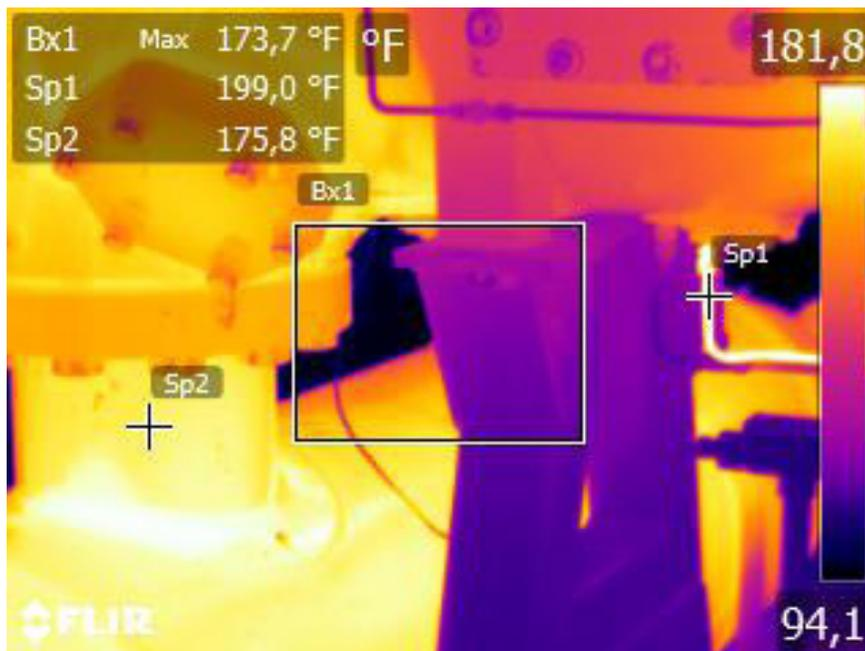
Figura 8. Alta temperatura de venteo de la caja de empaquetadura – Fuga crítica. Fuente: El autor.
