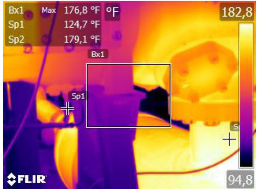
Figura 7. Temperatura de Funcionamiento Normal del venteo de la caja de empaquetadura. Fuente: El autor.
