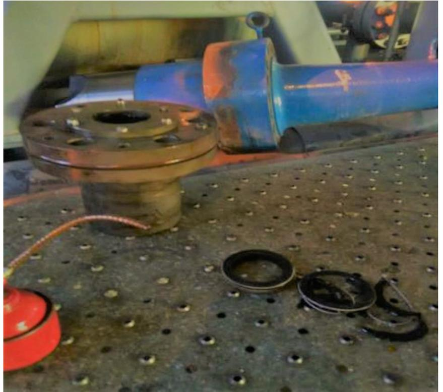
Figura 9. Condición de anillos - Caja de empaquetadura. Fuente: El autor.
