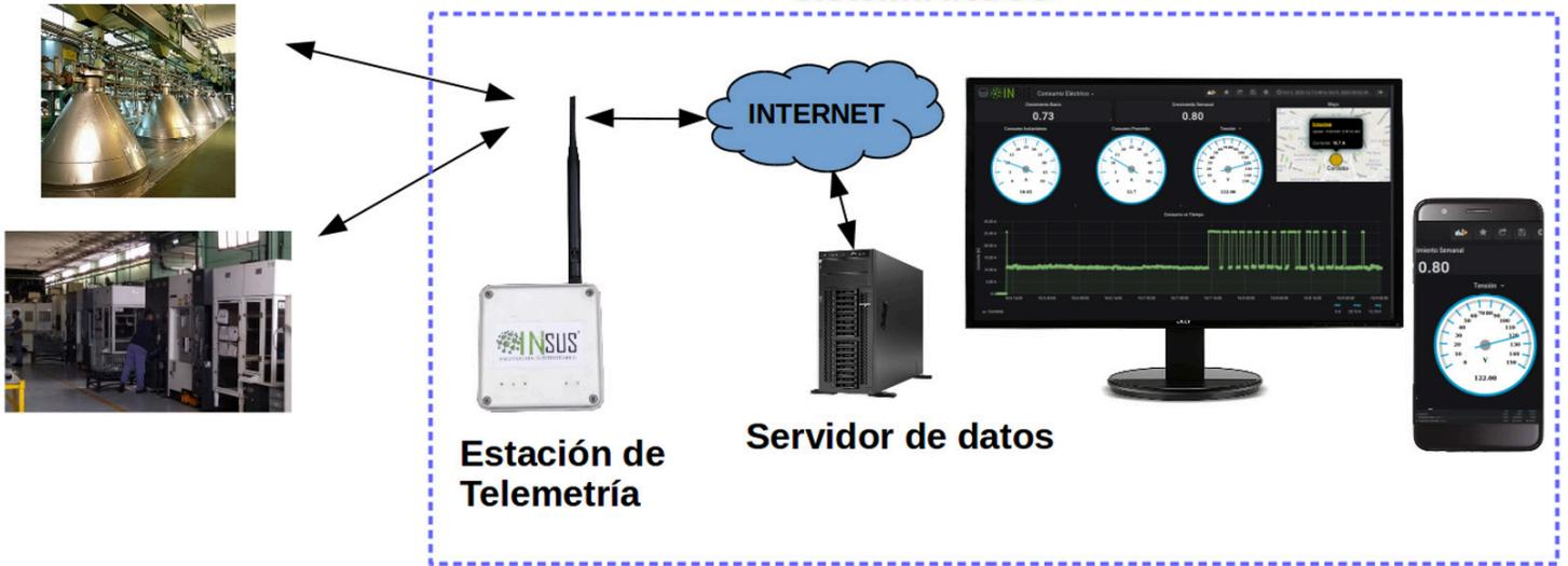
Figura 1. Arquitectura del sistema de monitoreo y control de activos. Fuente: Los autores.
