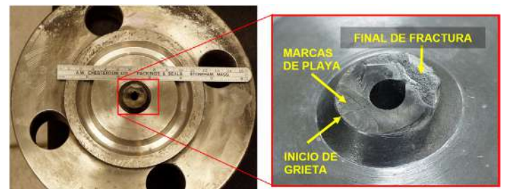
Figura 4. Cara de fractura de la grieta en el termopozo
