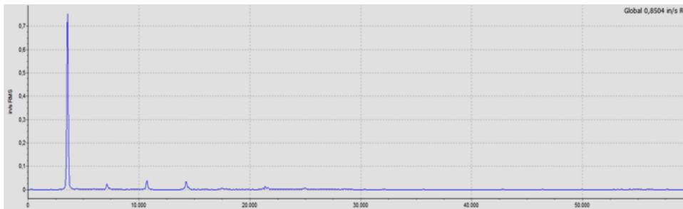
El peso del ventilador es de 45 kg, para realizar el balanceo se estima una masa residual permisible considerando la norma ISO 1940/1, con calidad G 2.5 el cual será de 9.54 g.
