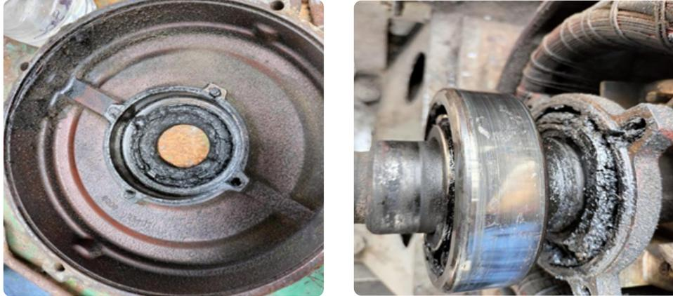
Rodamiento 6311. Se pudo detectar ajuste fuera de lo normal (holgura) en la caja de los rodamientos, provocando la ralladura de la pista exterior del rodamiento
