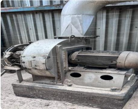
En análisis de forma de onda se puede observar la limitación de la vibración, principal indicativo de holgura mecánica tipo C en el motor es probable exista una combinación de desbalance y holguras principalmente en los alojamientos o rodamientos del motor. Por lo cual se recomienda una vez se corrija el desajuste del alojamiento y rodamientos del motor, realizar un balanceo dinámico del ventilador.
