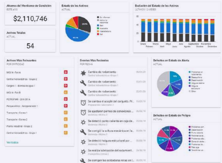
Figura 8. Panel de control de mantenimiento predictivo en software Power-MI.
