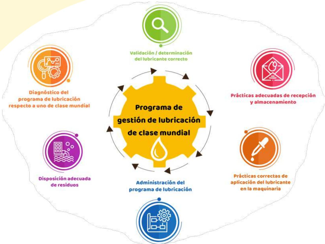
Figura 2. Ciclo de un programa de lubricación de clase mundial.
