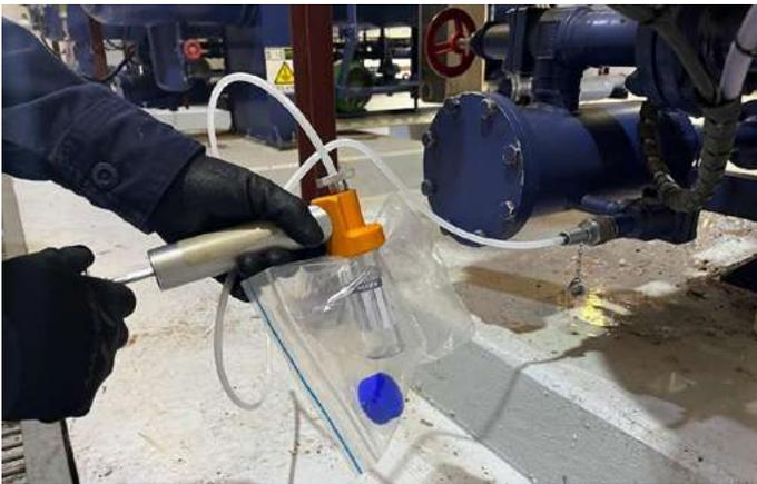
**Figura 5. Procedimiento adecuado de toma de muestra de aceite.**
