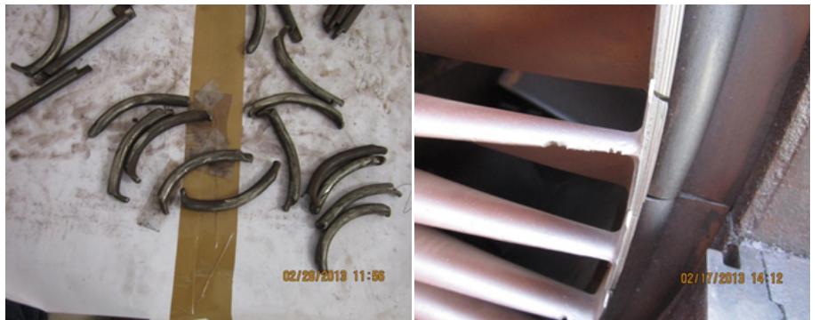
Clavijas liberadas de una Turbina y álabes de 3ra etapa impactados por las clavijas. Fuente: Propia
