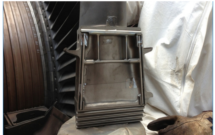
Clavijas Tri-sello Siendo Instaladas en una turbina - FUENTE: Propia
