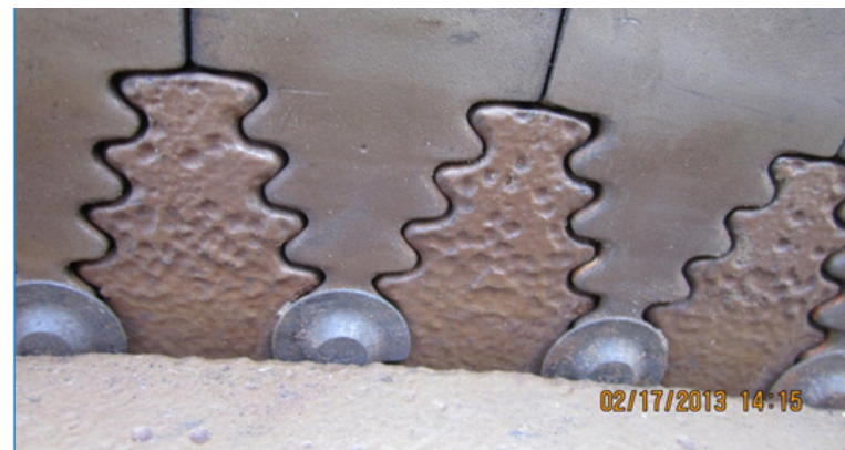
Desbloqueo de Cierre Giratorio Evidenciado en Turbina - fuente: Propia
