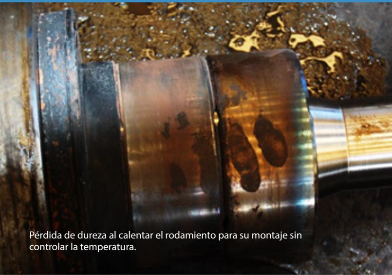
Pérdida de dureza al calentar el rodamiento para su montaje sin controlar la temperatura.
