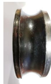
Falla en rodamiento por exceso de grasa, cambio en la coloración de los caminos de rodadura.
