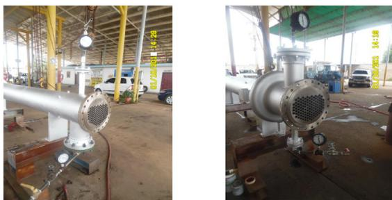
**Fotografías 11 y 12.** Intercambiador de calor HE-E101-A sometido a prueba hidrostática conservando el mismo haz tubular. Fuente: El autor.
