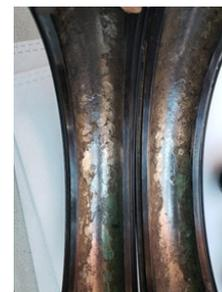
Aumento de temperatura en los caminos de rodadura debido a una escasez de lubricante.
