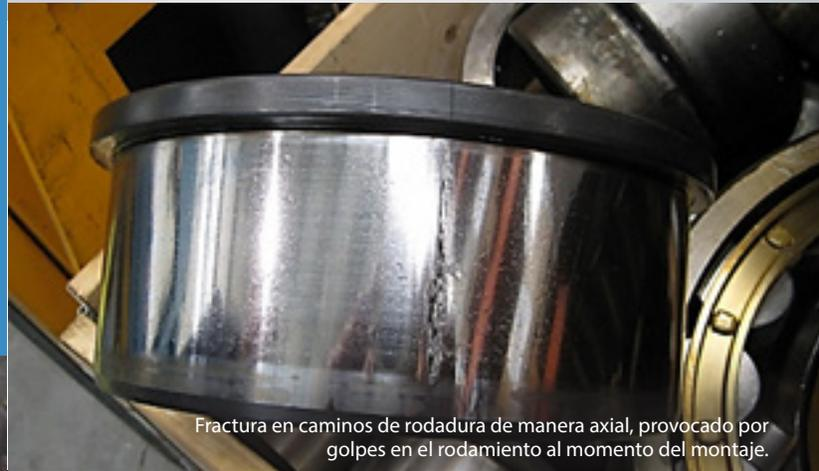
Fractura en caminos de rodadura de manera axial, provocado por golpes en el rodamiento al momento del montaje.
