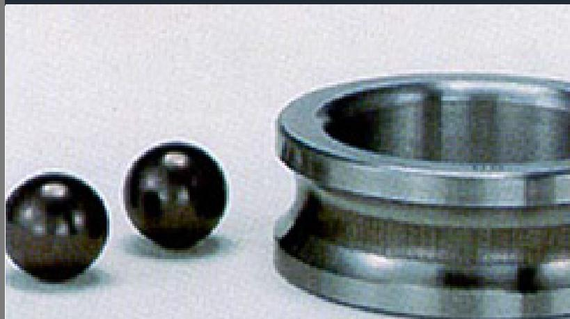
Paso de corriente en rodamientos montado en equipo con variador de frecuencia. (fuente skf)
