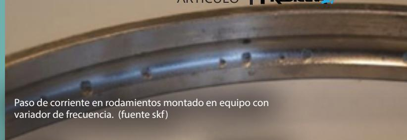
Paso de corriente en rodamientos montado en equipo con variador de frecuencia. (fuente skf)
