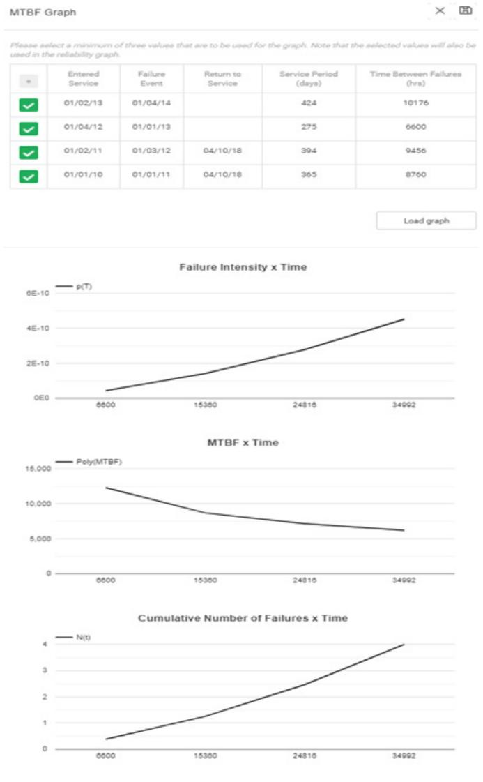
Figura 3.4. Gráficos de crecimiento de la fiabilidad basados en la fiabilidad 4.0. Fuente: Integrity PRO software.
