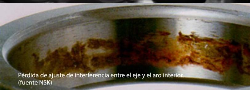
Pérdida de ajuste de interferencia entre el eje y el aro interior. (fuente NSK)
