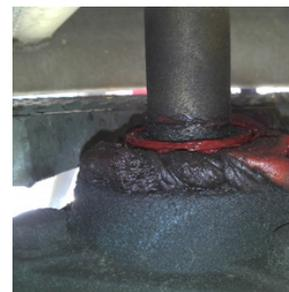
Soporte de fundición con exceso de lubricante, el sello dejó de funcionar, el rodamiento está comprometido y próximo a la falla.
