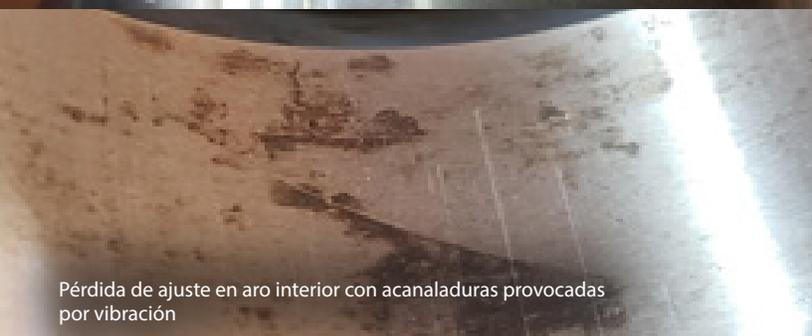
Pérdida de ajuste en aro interior con acanaladuras provocadas por vibración
