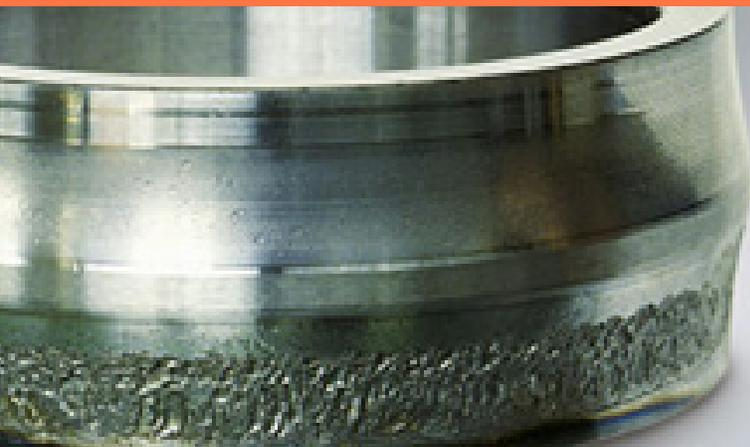
Rodamiento con fallo prematuro debido a una sobrecarga provocado por desalineación. (fuente NSK)
