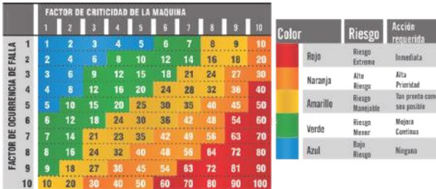
Figura 4. La matriz de Criticidad Global de la Maquinaria (CGM) incluye el Factor de Criticidad de la Máquina (FCM) sobre el eje de las X, el Factor de Ocurrencia de Fallas (FOF) sobre el eje de las Y, y cinco zonas de riesgo, cada una representada por un color diferente
