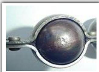
Figura 11 - Rodamiento lado acople del motor - Elementos Rotantes
