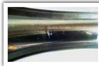
Figura 12 - Rodamiento lado acople del motor - Pista Externa
