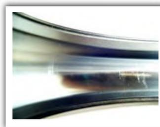
Figura 14 - Rodamiento lado opuesto acople del motor - Pista Externa
