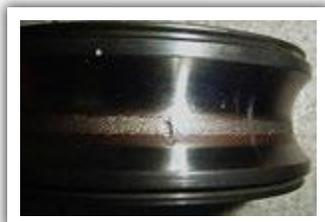
Figura 10 - Rodamiento lado acople del motor - Pista Interna
