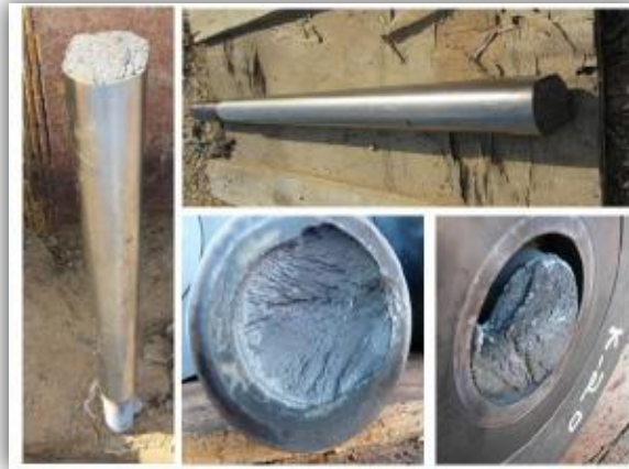
Figura N° 5. Barras de Pistón Luego de su Ruptura Fuente: Propia
