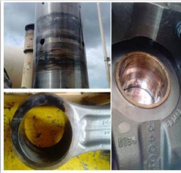
Figura N° 8. Daños Ocasionados por Efecto de No Reversión de Carga Fuente: Propia
