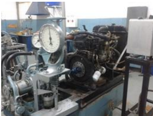
Figura No. 4 - Motor de combustión interna Diesel de 4 cilindros acoplado a un freno hidráulico
