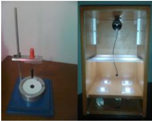
Figura No. 5 – Dispositivo para la obtención y registro de la mancha de aceite.
