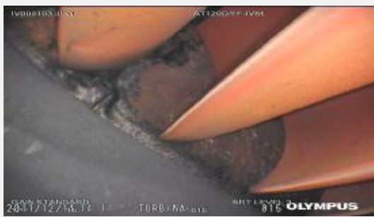
Fig.10. Bloques Térmicos 1 era Etapa (Fuente: EYM Solutions, Maturín)
