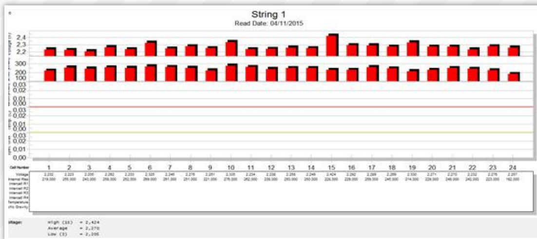
Muestra de una medición de baterías de celdas de 2V.
