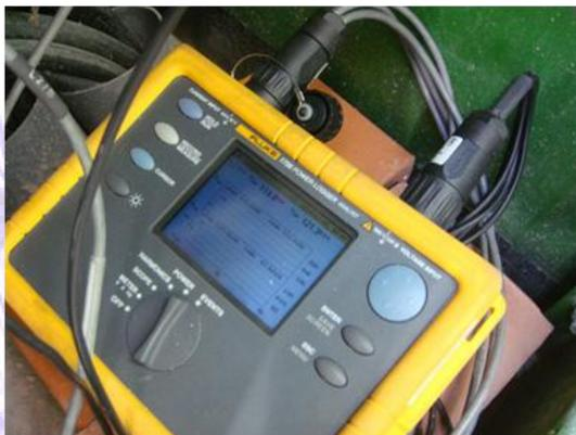
*Fig. N 4. Equipo de medición para auditoría de calidad de potencia.*
