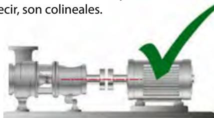
Una buena alineación entre los ejes de un sistema formado por un motor eléctrico y una máquina conducida, tendría las siguientes ventajas:
