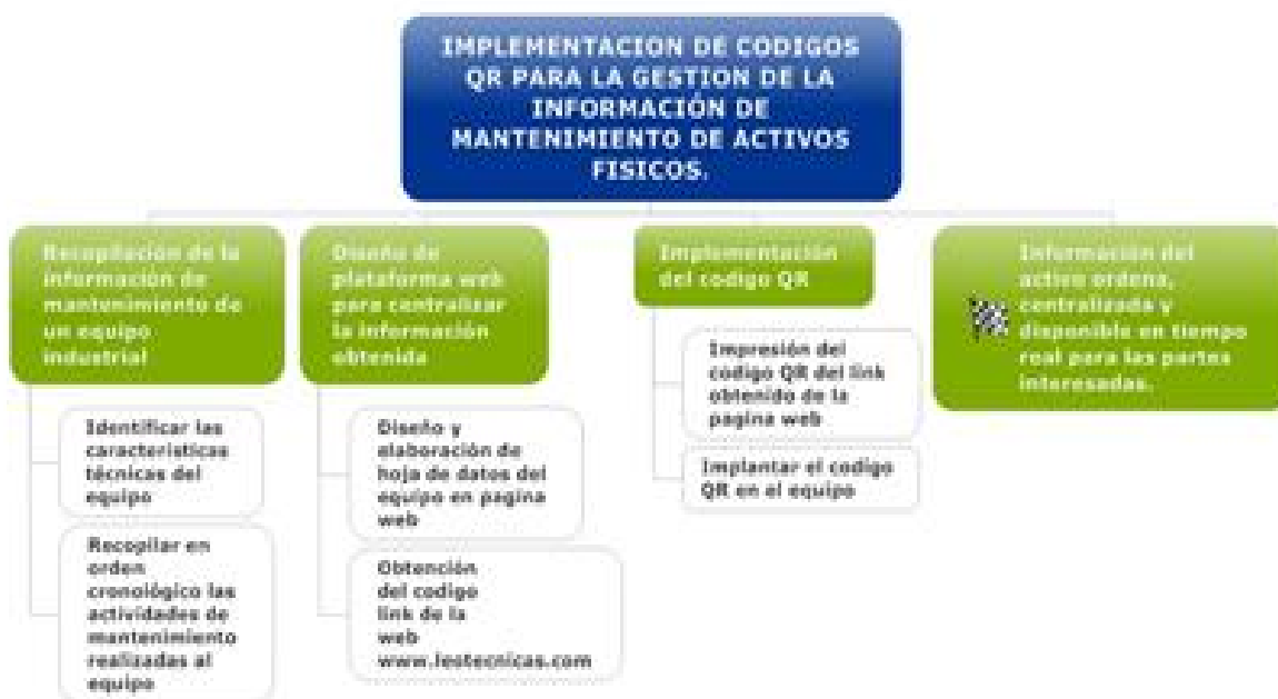
Imagen 6. Metodología de implementación de códigos QR para la gestión de la información de activos físicos.
