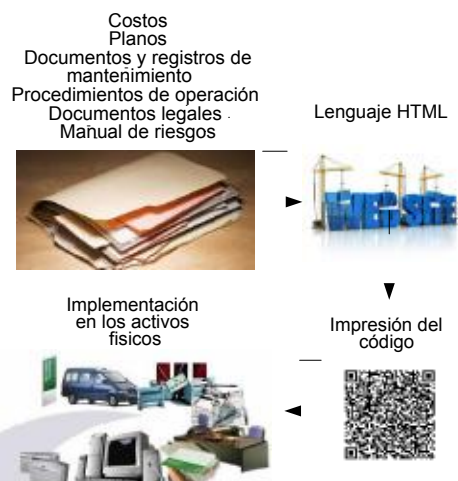
Imagen 1. Proceso de implementación de los códigos QR en la Gestión de Activos
