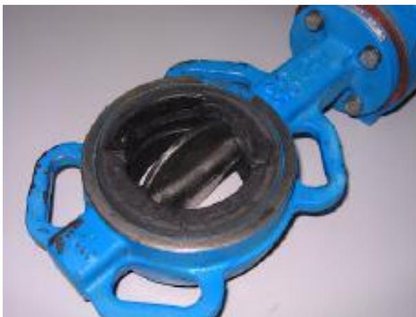
Ilustración 2 Daños en zona de cierre de una válvula de mariposa
