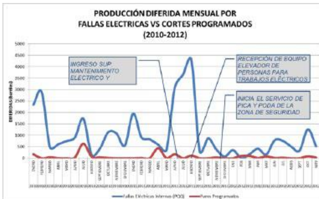
Figura 4. Producción diferida por fallas eléctricas vs cortes eléctricos programados. Fuente: Registro del caso de estudio.
