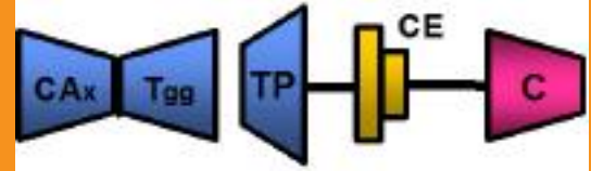
Fig.11.- Turbina Aeroderivada (CAx+Tgg) con Turbina de Potencia (TP)
