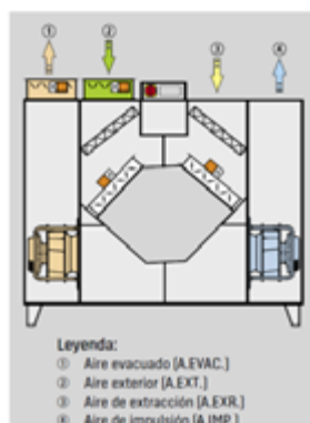
Climatizador CLK-Evo de Wolf (existen diferentes variantes). Indicación de las diferentes bocas de toma y expulsión de aire. Fuente: Wolf Ibérica
