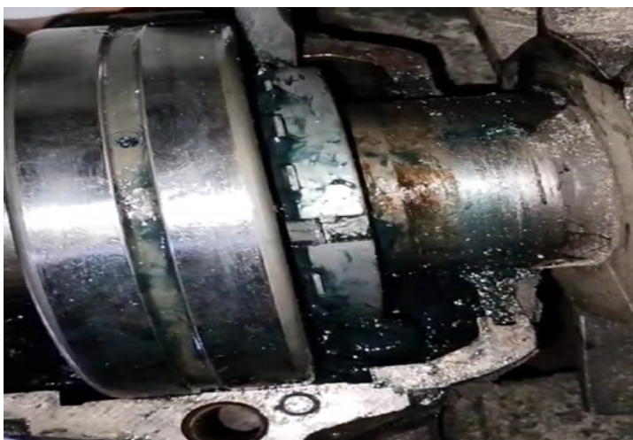
Chumacera lado libre, ventilador tipo cantiliver
