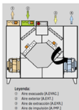
Climatizador CLK-Evo de Wolf (existen diferentes variantes). NUEVA variante con by-pass (marcado con flecha) que incorpora, para el modelo del by-pass, una nueva compuerta motorizada. Fuente: Wolf Ibérica
