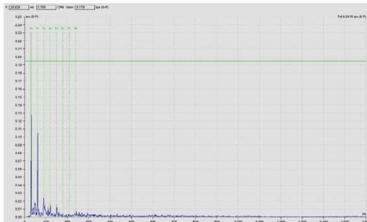
Espectro de vibraciones, 0.24 ips (O-Pk), chumacera lado libre, ventilador tipo cantiliver.
