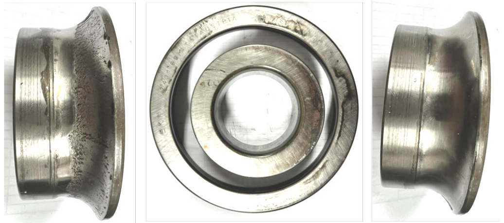
EN LA IMAGEN SE MUESTRA EL DAÑO ENCONTRADO EN LA PISTA INTERNA DEL RODAMIENTO 7414-B, DESPUÉS DE DESMONTAR LA POLEA.
