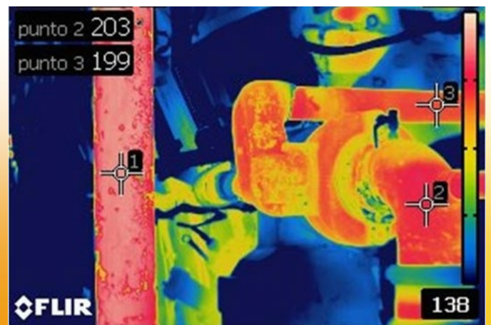
Fig 3. Termograma, paleta tipo arcoíris, motor full carga. Fuente propia.
