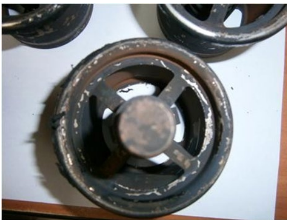
Fig 5. Imagen digital, termostato desmontado. Fuente propia.
