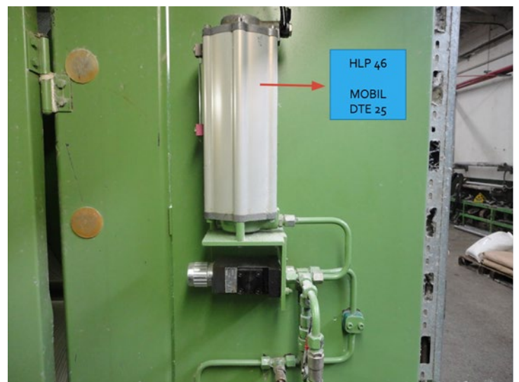
Fig.12. Sistema hidráulico tensor de la cadena de la secadora de la Engomadora Benninger Zell. Fuente propia.
