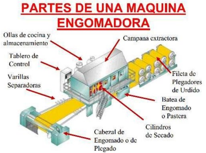
Fig. 5. Esquema general de partes de una engomadora textil.
