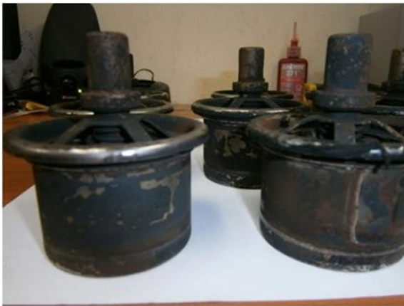
Fig 4. Imagen digital, termostato desmontado. Fuente propia.
