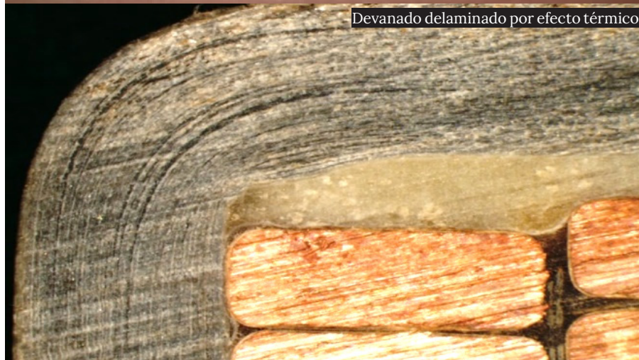
Devanado dañado por vibración de bobinas
