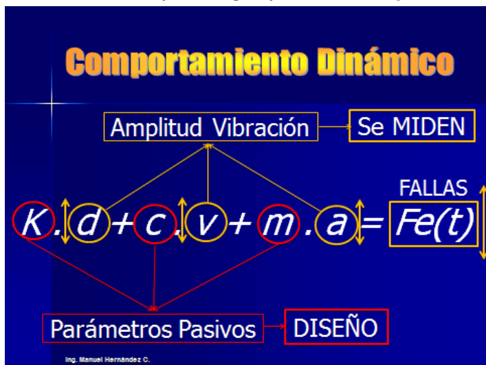
Figura 2. Comportamiento Dinámico Sistema Vibratorio. Fuente: El autor (2019)
