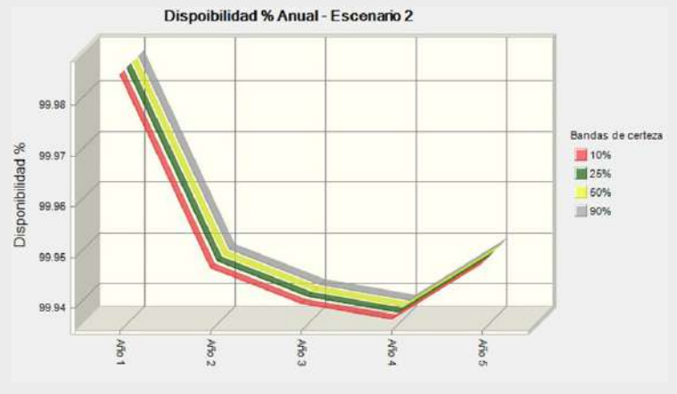
Gráfica 3.12. Perfil Estocástico de la Disponibilidad - Escenarios 2. Fuente: Resultados probabilísticos de simulación Monte Carlos con Crystal Ball.
