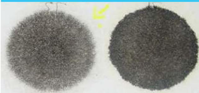
**Figura 1.** Baja y alta concentración de hollín en la prueba de la gota. *Fuente: El autor*
