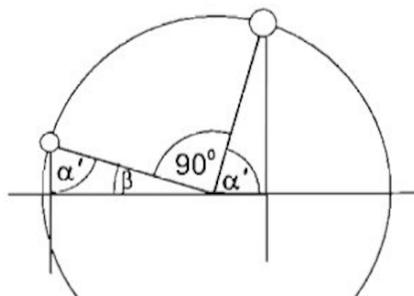
Поскольку мы хотим найти угол между горизонталью и радиусом, проведённым к большему шару (обозначим этот угол как  $\alpha'$ ), мы будем использовать  $\alpha' = 90^\circ - \beta$  (как показано на рисунке), чтобы определить требуемый угол. Технически это означает, что после обмена индексов в формуле для тангенса угла нам также нужно взять его обратное значение.
