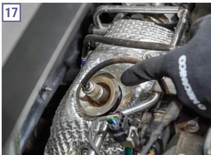
O motor Kappa 1.0 TGDI se apresenta como um propulsor de baixa complexidade, uma vez que a grande parte dos componentes têm um fácil acesso para o mecânico realizar a manutenção, como a sonda lambda pré e pós catalisador (17), que estão em uma posição de acessível para análise e reparo. Por sua vez, o sensor map (18) está montado no coletor de admissão, o que não gera complexidade na revisão, bem como, o corpo de borboleta localizado em um espaço sem dificuldade para verificação do equipamento.
