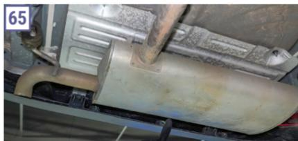
O intermediário já vem com o catalisador (64), além de ser de baixa complexidade para realizar a manutenção. Já o silencioso traseiro (65), que está fixado na carroceria com dois coxins. A linha de combustível conta com uma proteção plástica (66), que é de fácil retirada para
