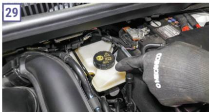
Sobre o óleo de motor, tanto o motorista quanto o mecânico têm ingresso facilitado com um bocal de enchimento e vareta de verificação do nível do lubrificante do conjunto motriz (28), o que é semelhante ao Creta. O reservatório do fluido de freio (29) requer um pouco de atenção, pois é necessário um funil para enchê-lo com o fluido de freio DOT4, o que requer mais atenção do mecânico.
