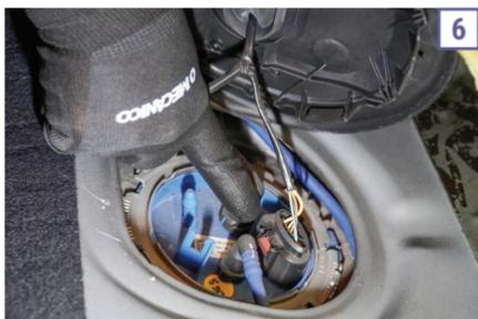
Essa peça é responsável por enviar um sinal PWM para a bomba de combustível para controlar a pressão e a vazão da linha conforme a necessidade do motor. Portanto, não há mais uma pressão fixa: o valor varia conforme a rotação e a carga do motor. Veja as variações nos gráficos.
