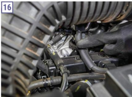
o turbocompressor (15). “Essa turbina gera uma pressão e tem uma ligação e um intercooler na frente do propulsor, que está conectado por meio de mangueira até o corpo de borboleta”. Por ser um veículo turbo, ele tem uma bomba de vácuo (16) na parte traseira do conjunto motriz, que é movimentada pelo eixo comando de admissão e, também, não oferece dificuldades para o reparo. “A função da bomba de vácuo é gerar vácuo para o sistema do servo freio”, analisa China.
