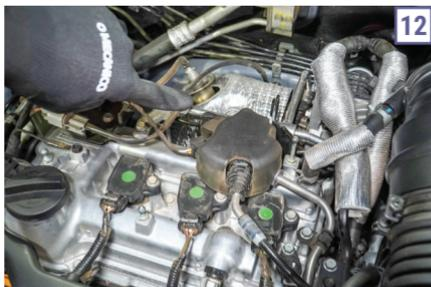
motriz. Após fazer isso, ficam à vista as três bobinas, uma vez que esse propulsor tem três cilindros. “É muito fácil fazer a remoção para e o diagnóstico do sistema de ignição, sem grandes interferências”, aponta Carlos Eduardo Vieira.
