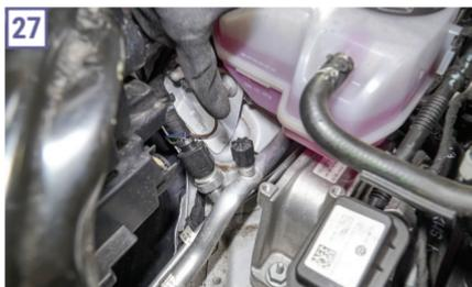
no lado direito do motor com um bocal de fácil acesso, mas se for necessário fazer um reparo será mais complexo do que o Creta, uma vez que no T-Cross ele fica na parte inferior do veículo, precisando remover a roda e o para-barro para fazer a manutenção.
