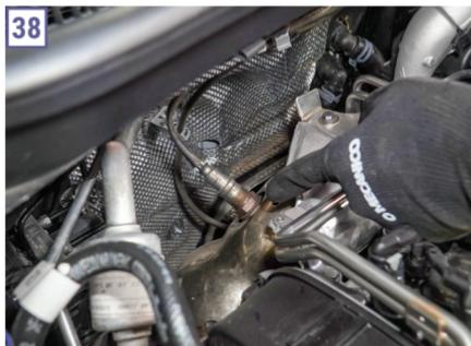
A sonda lambda do T-Cross **(38)** já é uma sonda pré-catalisador e uma sonda de banda larga, o que confere mais precisão, e a sonda pós-catalisador é uma comum. “A sonda de banda larga permite ter uma resposta mais precisa com o diagnóstico por consumo de corrente. Por sua vez, a sonda planar, que é a comum, é por variação de tensão”, disse China.
