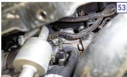
Todavia, o motor de partida **(53)** não é de fácil acesso. “O motor de partida está atrás do compressor do ar-condicionado, o que dificulta fazer a manutenção deste componente”, analisa Carlos Vieira.
