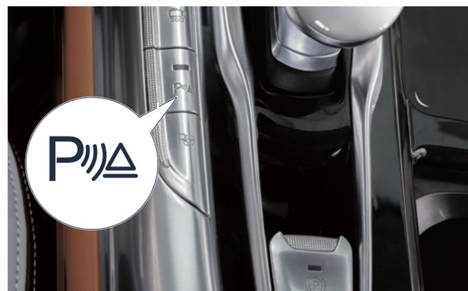
Les capteurs de stationnement avant sont activés par défaut lorsque le véhicule est allumé. Vous pouvez activer/désactiver les capteurs via le commutateur PDC au niveau du levier de vitesses.
