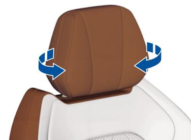
Sur l'appuie-tête des sièges avant, les côtés peuvent être ajustés. Réglez manuellement les lames des deux côtés vers l'intérieur et l'extérieur.
