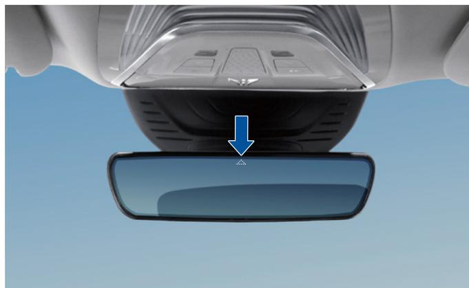
Le véhicule est équipé d'un rétroviseur intérieur automatique anti-éblouissement. Lorsque vous conduisez la nuit, si une lumière vive survient à l'arrière, le rétroviseur intérieur s'ajuste automatiquement pour réduire la forte réflexion de la lumière.
