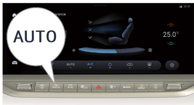
Appuyez sur le bouton de AUTO (mode automatique), le voyant du bouton s'allumera, la climatisation passera en mode automatique et les éléments suivants seront automatiquement contrôlés en fonction de la valeur de température définie :
