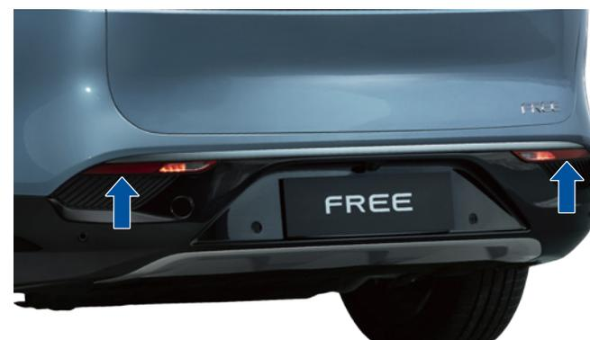
Le catadioptre arrière est utilisé pour réfléchir la lumière de l'arrière du véhicule, rappelant au conducteur à l'arrière du véhicule de maintenir une distance de sécurité pendant la conduite.
