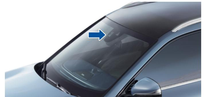
Le capteur de lumière automatique est situé en haut au centre du pare-brise. Ne couvrez pas cette zone et maintenez-la propre afin de ne pas interférer la fonction de contrôle automatique de la lumière.
