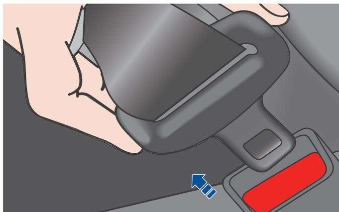
1. Maintenez une partie de la ceinture de sécurité contre la boucle pour empêcher la ceinture de sécurité de se rétracter trop rapidement ;
