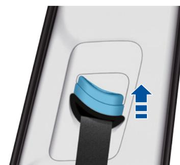
Déplacer vers le bas : appuyez sur le bouton de déverrouillage de réglage de la hauteur et déplacez-le vers le bas (dans le sens indiqué par la flèche dans la figure ci-dessous), réglez la sangle d'épaule à la hauteur appropriée si nécessaire, puis relâchez le bouton de déverrouillage. Lorsque vous entendez un « clic », cela signifie que le réglage est verrouillé.
