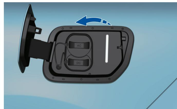
Balayez vers la droite sur l'écran de contrôle pour afficher l'aperçu du menu et appuyez sur « Open C. Port » (« Couvercle de charge ») et le couvercle de charge s'ouvre automatiquement. Lorsque le couvercle de charge est ouvert, vous pouvez le faire glisser manuellement vers l'intérieur pour le fermer.
