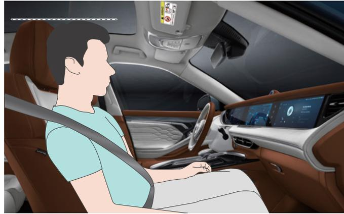
Asseyez-vous de sorte que tout le corps repose sur le siège, gardez le dos et les épaules alignés avec le dossier, et ajustez la hauteur de l'appuie-tête de sorte que le bord supérieur soit au niveau de la tête.
