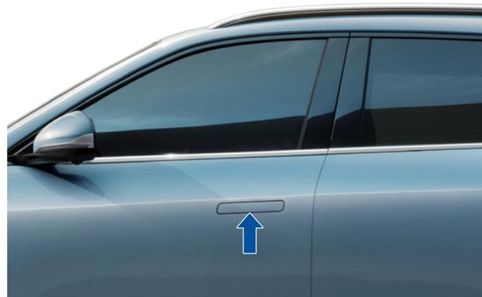
Le véhicule est équipé de poignées dissimulées pour réduire la résistance au vent et offrir une meilleure expérience de conduite.
