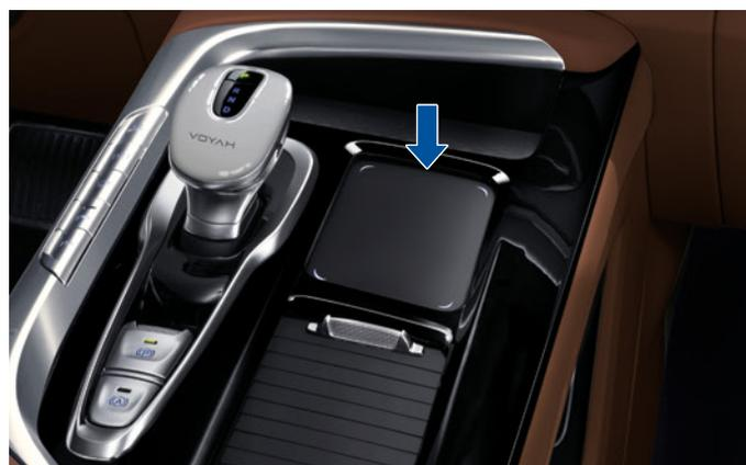
L'écran tactile est situé sur le côté droit du levier de vitesses et est principalement utilisé pour reconnaître diverses informations de mouvement afin d'exécuter les fonctions de commande correspondantes :
