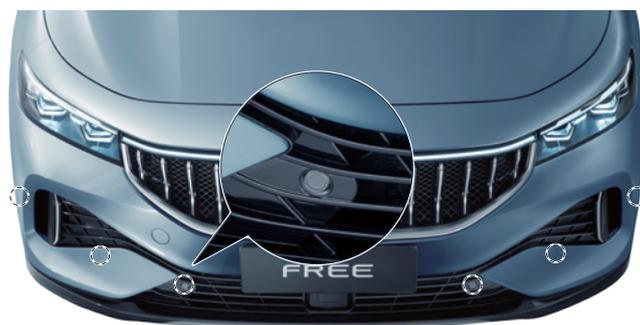
Les capteurs de stationnement avant sont fixés sur le pare-chocs avant du véhicule.
