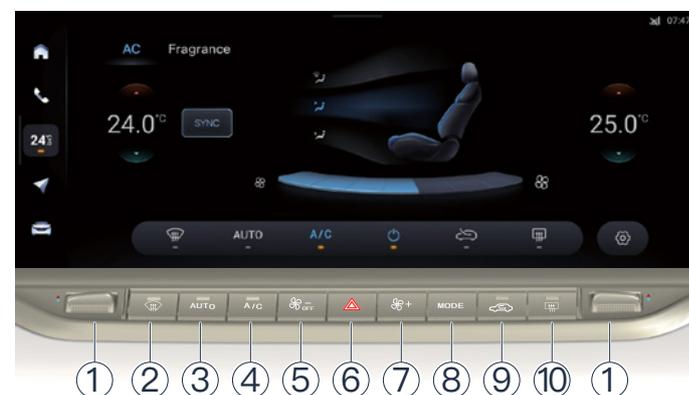
1. Bouton pour régler la température dans les zones gauche et droite
