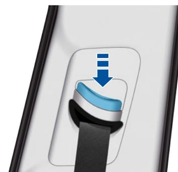
Sans appuyer sur le bouton, essayez de déplacer le réglage de la hauteur vers le bas pour vérifier si le réglage est bloqué.
