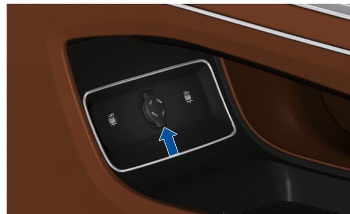
Le connecteur d'alimentation 12 V avant est situé sous l'accoudoir central et peut être utilisé lorsque le couvercle est ouvert. La puissance maximale admissible est de 120 W.
