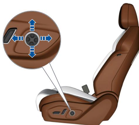
Le support lombaire peut être réglé vers le haut, vers le bas, et d'avant en arrière avec le bouton de réglage.
