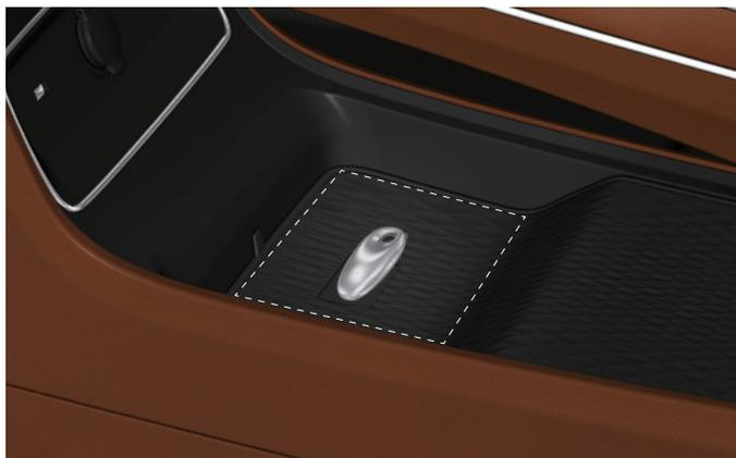
Lorsque la batterie de la clé intelligente est faible, placez la clé intelligente dans la zone de démarrage d'urgence, sous la console centrale (représentée par la ligne pointillée sur la figure ci-dessus). Appuyez sur la pédale de frein et appuyez sur le bouton START/STOP pour démarrer le véhicule en urgence. Toutes les portes et le coffre doivent avoir été fermés au préalable.
