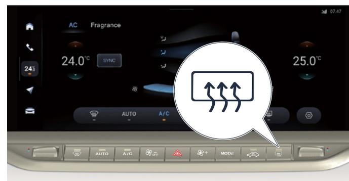
Appuyez sur le bouton de chauffage du rétroviseur extérieur. Le voyant s'allume et la fonction de chauffage des rétroviseurs extérieurs est activée. Cela peut éliminer la buée et la glace dans les rétroviseurs extérieurs et la lunette arrière. Appuyez à nouveau sur le bouton pour désactiver la fonction de chauffage.
