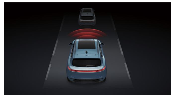
FCW surveille le risque de collision entre le véhicule en question et les objets tels que les piétons et les véhicules qui précèdent à l'aide du radar MMW et de la caméra frontale intelligente. En cas de risque de collision, le véhicule déclenchera une alarme sonore et visuelle pour alerter le conducteur.
