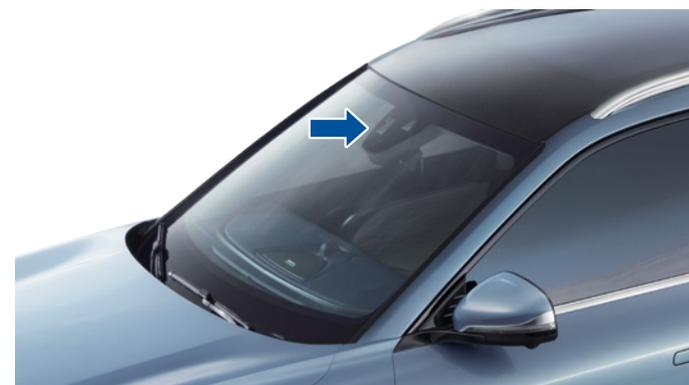
L'emplacement du capteur de pluie et de lumière est indiqué par la flèche de la figure ci-dessus. Lorsque le capteur de pluie et de lumière détecte de la pluie, les fenêtres se ferment automatiquement.
