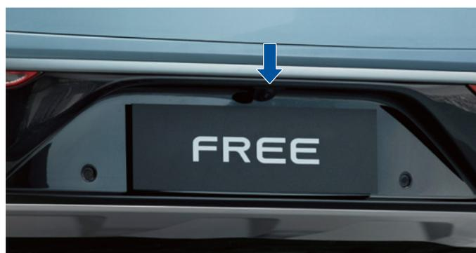
Le voyant de la plaque d'immatriculation arrière est situé à côté de la caméra de recul et éclaire la plaque d'immatriculation du véhicule.
