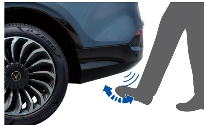
Accédez à la zone de détection du véhicule avec la clé intelligente, bougez le pied au milieu du pare-chocs arrière à une hauteur d'au moins 10 cm en dessous de celui-ci et le coffre s'ouvrira /se fermera.
