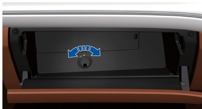
L'interrupteur de ventilation de la boîte à gants est situé dans la boîte à gants.
