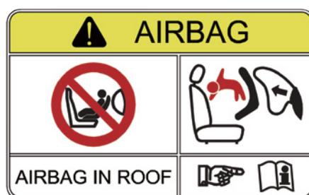
Une étiquette d'avertissement est attachée au pare-soleil droit, avertissant principalement les passagers du risque de déploiement de l'airbag avant. Veuillez lire et respecter les instructions sur l'étiquette.
