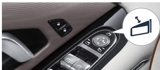
Appuyez sur le bouton illustré sur la figure pour déplier/replier les rétroviseurs extérieurs
