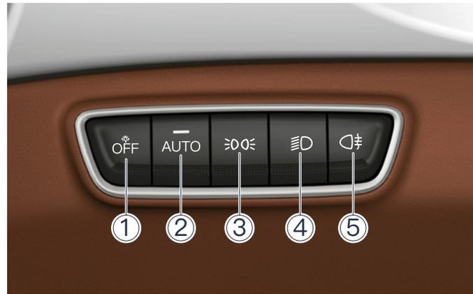
L'interrupteur d'éclairage combiné est situé sur le côté gauche du tableau de bord.
