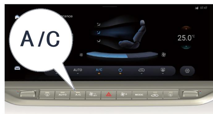
Appuyez sur le bouton de refroidissement de la climatisation, le voyant du bouton s'allumera et le système de climatisation A/C activera la fonction de refroidissement.
