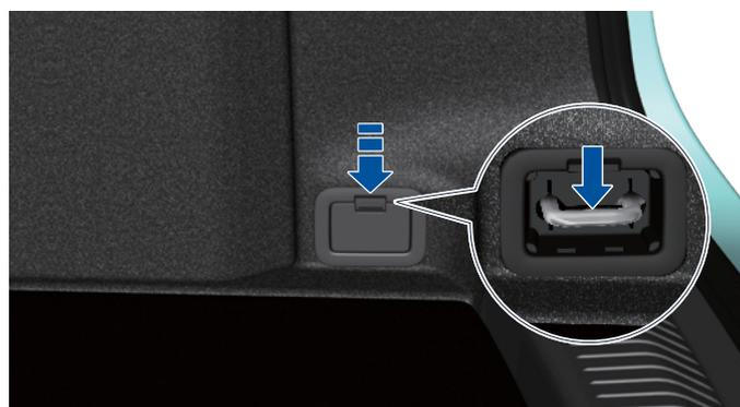
Utilisez votre doigt pour appuyer sur le couvercle dans la direction indiquée par la flèche dans l'image ci-dessus. Une fois le couvercle déverrouillé, ouvrez-le et utilisez le crochet de fixation.
