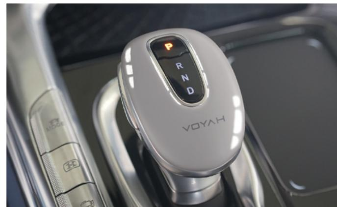
Le véhicule a quatre positions de vitesse : P, R, N et D. Une fois que le véhicule est entré en mode READY (« Prêt »), appuyez sur la pédale de frein et changez de vitesse, le voyant de vitesse correspondant sur le levier de vitesses s'allume et la vitesse correspondante s'affiche sur l'écran du conducteur.
