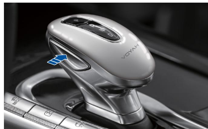
Lorsque vous changez de vitesse à partir de P ou R, appuyez sur le bouton de déverrouillage sur le côté du levier de vitesses (comme indiqué par la flèche sur la figure ci-dessus).
