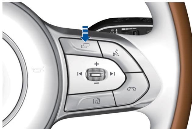
Les informations sur l'écran du conducteur peuvent être modifiées à l'aide du bouton de menu sur le volant pour afficher la pression et la température actuelle des pneus du véhicule.
