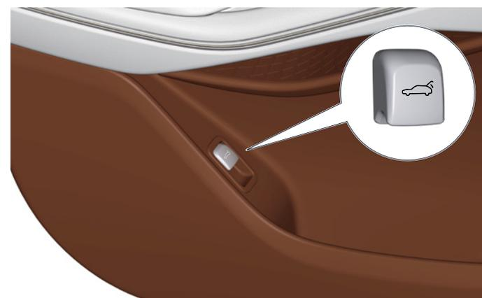
Lorsque le véhicule est à l'arrêt, soulevez l'interrupteur du coffre côté conducteur et le coffre peut être ouvert ; appuyez sur le bouton du coffre côté conducteur et le coffre peut être fermé.
