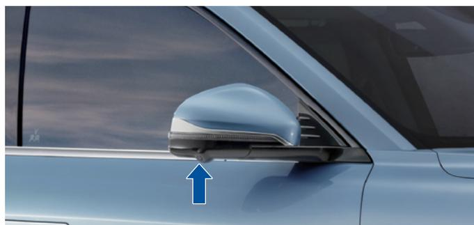
Les caméras gauche et droite sont situées en bas des rétroviseurs latéraux gauche et droit et sont utilisées pour enregistrer la zone latérale du véhicule.
