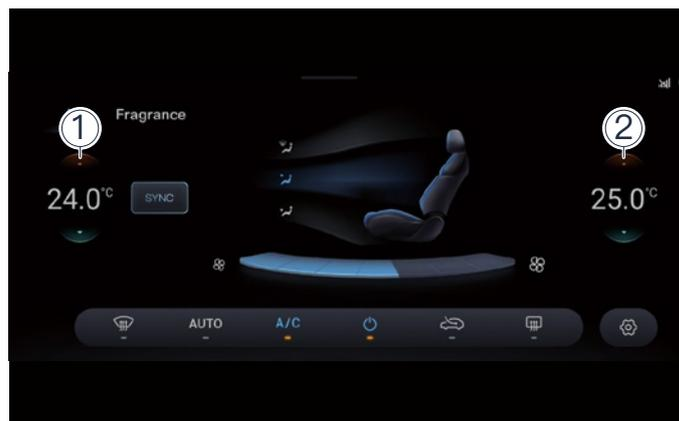
En mode de contrôle bi-zone, les températures dans les zones du conducteur et du passager avant peuvent être réglées séparément :
