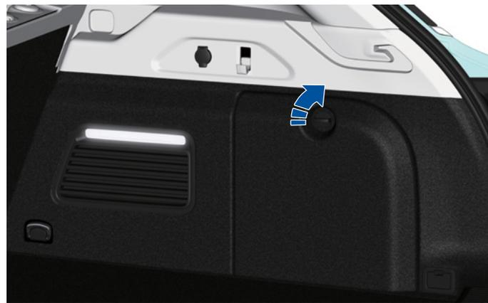
Tournez le bouton de la plaque de recouvrement de 90° dans le sens des aiguilles d'une montre pour ouvrir le couvercle ou de 90° dans le sens inverse des aiguilles d'une montre pour fermer le couvercle.
