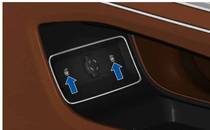
Sous l'accoudoir central avant se trouvent deux ports USB de type A dont la puissance de charge est de 10,5 W et qui prennent en charge le transfert de données.
