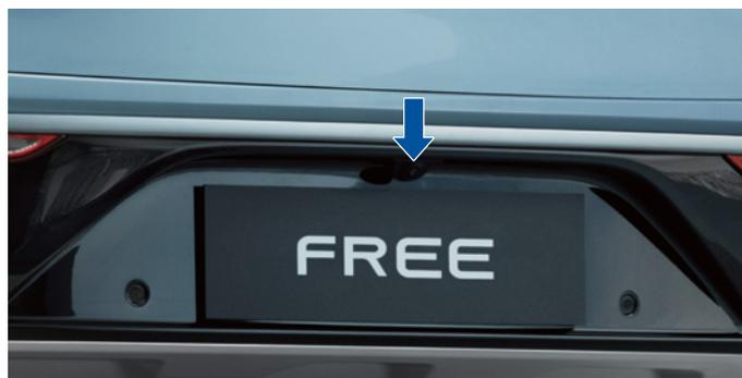
La caméra arrière est située à côté de l'éclairage de la plaque d'immatriculation sur le pare-chocs arrière et est utilisée pour détecter la zone derrière le véhicule. Lorsque R est sélectionné, la caméra de recul s'affiche à l'écran.
