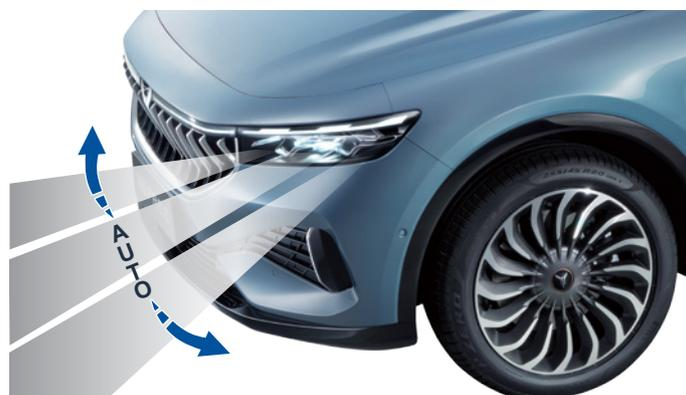
Le système AFS ajuste automatiquement l'angle du faisceau lumineux en fonction de l'état de charge du véhicule (pas de charge, charge légère, charge moyenne, charge maximale) pour fournir la zone d'éclairage correcte. La hauteur du feu de route peut ne pas s'ajuster automatiquement dans les situations suivantes, notamment :
