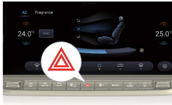
L'interrupteur des feux de détresse est situé au centre du panneau de commande physique de la climatisation. En cas de problème au véhicule ou lorsque vous êtes en danger, appuyez sur l'interrupteur des feux de détresse. Les indicateurs avant, arrière et latéral gauche clignoteront de manière synchrone ; appuyez à nouveau sur l'interrupteur des feux de détresse pour éteindre les feux de détresse.
