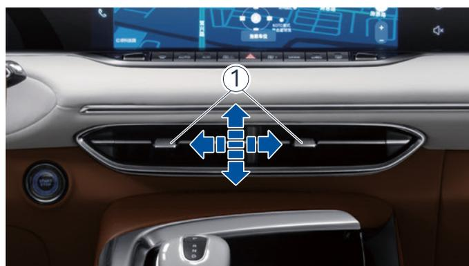
Déplacez la grille vers le haut, vers le bas, vers la gauche et vers la droite pour régler la direction de la sortie d'air de la grille d'aération centrale avant, et déplacez-la vers l'extrémité gauche/droite pour la fermer.
