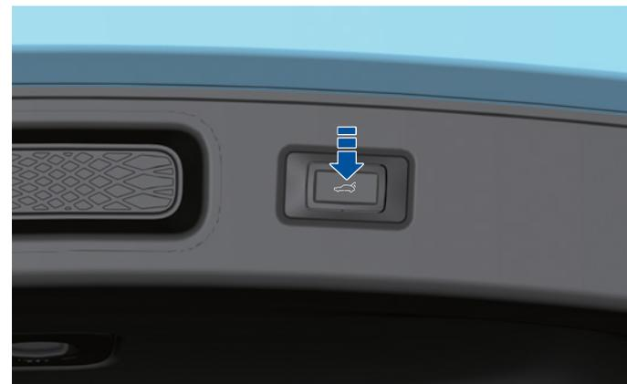
Appuyez sur le bouton de verrouillage interne du coffre pour
