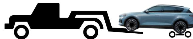
La dépanneuse se situe sous les roues arrière de la voiture tractée.
