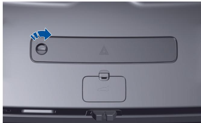
Le triangle de sécurité est situé à l'intérieur du coffre. Ouvrez le coffre, tournez le bouton de la plaque de recouvrement dans le sens des aiguilles d'une montre comme indiqué sur l'image ci-dessus, ouvrez le couvercle et retirez le triangle de sécurité.
