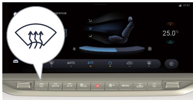
Appuyez sur le bouton de désembuage du pare-brise, le voyant du bouton s'allumera, la fonction de désembuage sera activée et le système effectuera automatiquement les réglages suivants :
