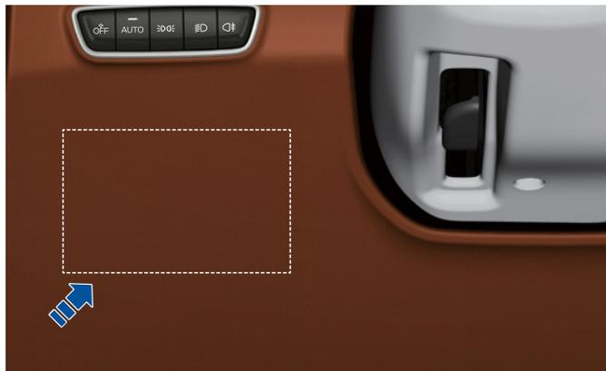
1. Retirez le panneau de garniture sur le côté gauche du volant.
