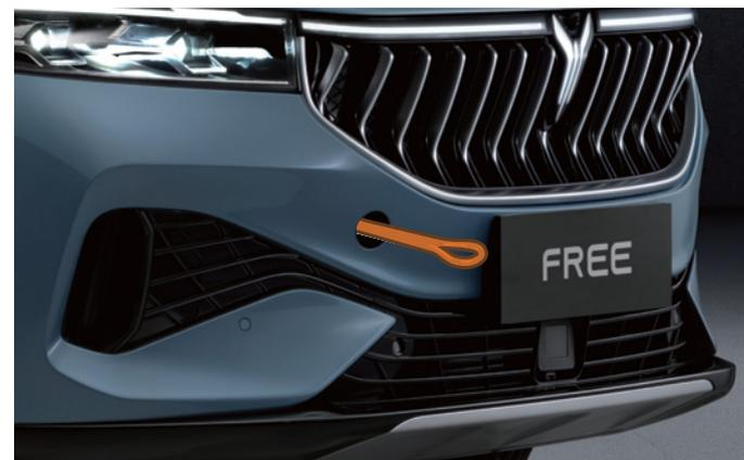
4. Connectez l'anneau de remorquage. Il est recommandé d'utiliser une corde de remorquage spécialement conçu pour le remorquage de véhicules.
