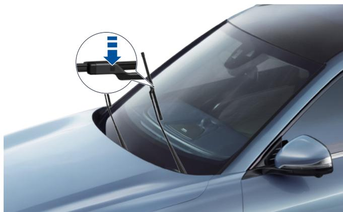
1. Activez le mode d'entretien des essuie-glaces avant et l'essuie-glace avant s'arrêtera sur le côté gauche du pare-brise.
