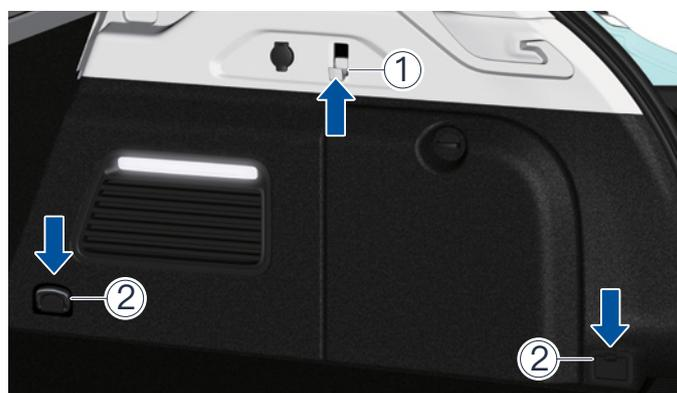
Les crochets sur les côtés gauche et droit du compartiment à bagages peuvent être utilisés pour suspendre des objets légers. Les crochets de fixation (2) sur les côtés gauche et droit du compartiment à bagages peuvent être utilisés pour fixer et sécuriser des articles plus volumineux placés dans le compartiment à bagages.
