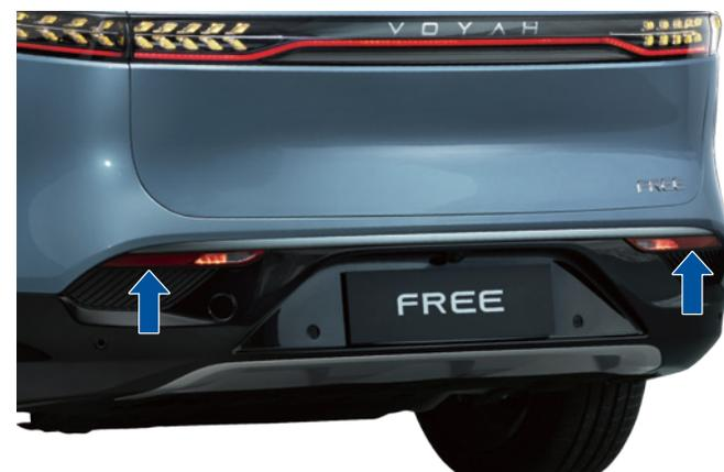
Der Heckreflektor dient dazu, das Licht des hinteren Fahrzeugs zu reflektieren und so den Fahrer daran zu erinnern, während der Fahrt einen Sicherheitsabstand zum vorderen Fahrzeug einzuhalten.
