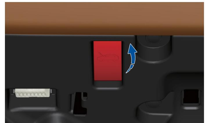
Ziehen Sie die Motorhaubenentriegelung zweimal schnell und heben Sie die Motorhaube an, um sie zu öffnen. Wenn die Motorhaube geöffnet wird, erscheint eine Meldung auf dem Fahrerbildschirm.
