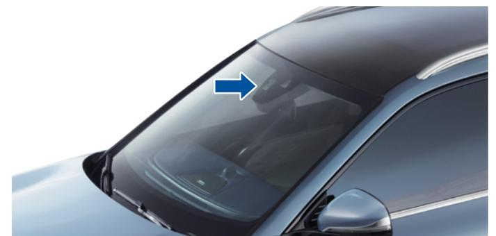
Der automatische Lichtsensor befindet sich oben in der Mitte der Windschutzscheibe. Decken Sie diesen Teil nicht ab und halten Sie ihn sauber, um die automatische Lichtsteuerungsfunktion nicht zu beeinträchtigen.
