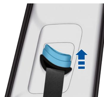
Nach unten bewegen: Drücken Sie den Entriegelungsknopf für die Höhenverstellung und bewegen Sie ihn nach unten (in der durch den Pfeil in der Abbildung unten angezeigten Richtung), stellen Sie den Schultergurt bei Bedarf auf die entsprechende Höhe ein und lassen Sie dann den Entriegelungsknopf los. Wenn Sie ein „Klick“-Geräusch hören, bedeutet dies, dass die Einstellung gesperrt ist.
