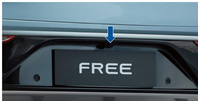
Die hintere Kamera befindet sich neben der Kennzeichenbeleuchtung an der hinteren Stossstange und dient zur Erkennung des Bereichs hinter dem Fahrzeug. Wenn R aktiviert ist, wird die dynamische Rückfahrlinie auf dem Bildschirm angezeigt.
