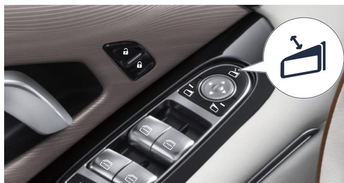
Zum Aus-/Einklappen der Aussenspiegel drücken Sie die in der Abbildung dargestellte Taste.
