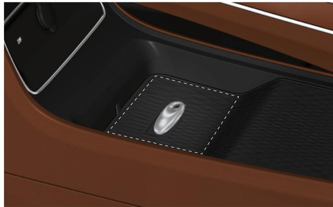
Wenn die Batterie des Smart Keys zu schwach ist, platzieren Sie den Smart Key im Notstartbereich unter der Mittelkonsole (dargestellt durch die gestrichelte Linie in der Abbildung oben). Drücken Sie das Bremspedal und drücken Sie die START / STOPP-Taste, um das Fahrzeug im Notfall zu starten. Voraussetzung ist, dass alle Türen und die Heckklappe geschlossen sind.
