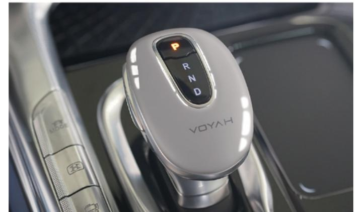
Das Fahrzeug hat vier Fahrstufen: P, R, N und D. Nachdem das Fahrzeug in den READY-Modus gegangen ist, drücken Sie das Bremspedal und wechseln Sie die Fahrstufeg. Die entsprechende Anzeige am Wahlhebel leuchtet auf und die entsprechende Fahrstufe wird auf dem Fahrerbildschirm angezeigt.
