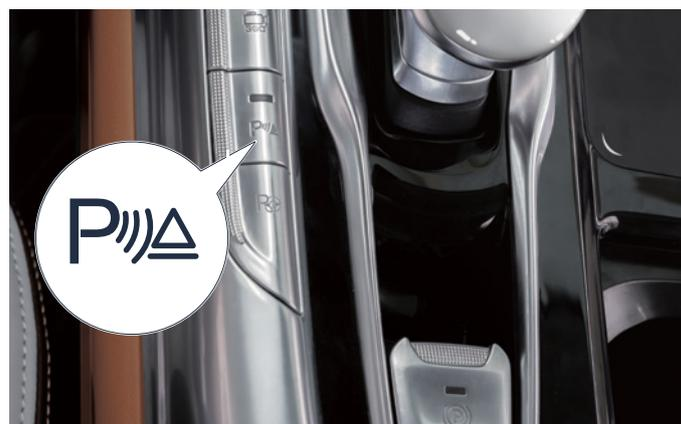
Die vorderen Parksensoren sind standardmässig aktiviert, wenn das Fahrzeug eingeschaltet ist. Sie können die Sensoren über den PDC-Schalter in der Mittelkonsole aktivieren / deaktivieren.
