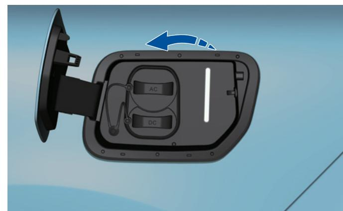
Wischen Sie auf dem Steuerbildschirm nach rechts, um die Menüübersicht anzuzeigen, und drücken Sie "Open C. Port" (die Ladeöffnung). Die Ladeklappe öffnet sich automatisch. Wenn die Ladeklappe geöffnet ist, können Sie sie manuell hineindrücken, um sie zu schliessen.
