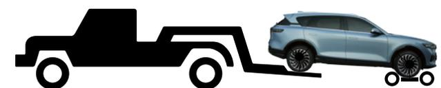
Der Wagen befindet sich unter den Vorderrädern des gezogenen Fahrzeugs.
