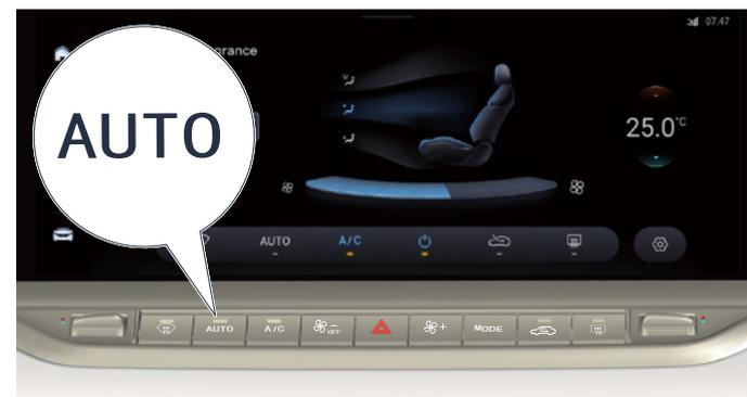
Drücken Sie die Auto-Modus-Taste, die Tastenanzeige leuchtet auf, die Klimaanlage wechselt in den Auto-Modus und die folgenden Elemente werden automatisch entsprechend dem eingestellten Temperaturwert gesteuert:
