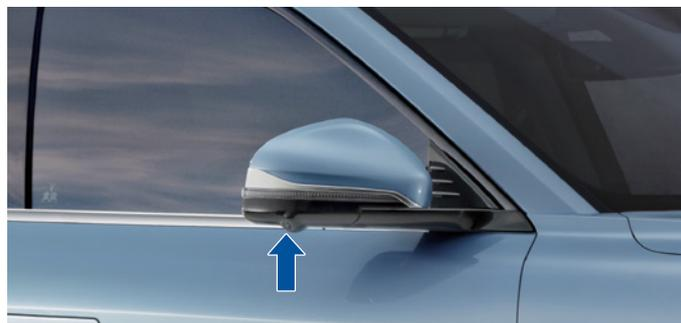
Die linke und rechte Kamera befinden sich am unteren Rand des linken und rechten Aussenspiegels und werden verwendet, um den Seitenbereich des Fahrzeugs zu registrieren.
