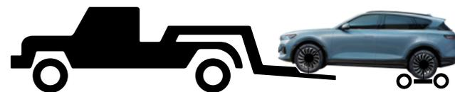
Der Wagen befindet sich unter den Hinterrädern des gezogenen Fahrzeugs.
