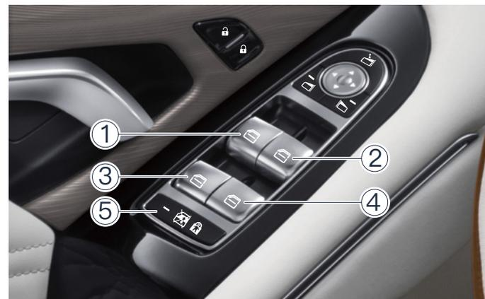
1. Elektrische Steuerung des linken vorderen Fensters
