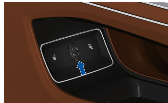
Die vordere 12-V-Steckdose befindet sich unter der Mittelarmlehne und kann bei geöffneter Abdeckung genutzt werden. Die maximal zulässige Leistung beträgt 120 W.
