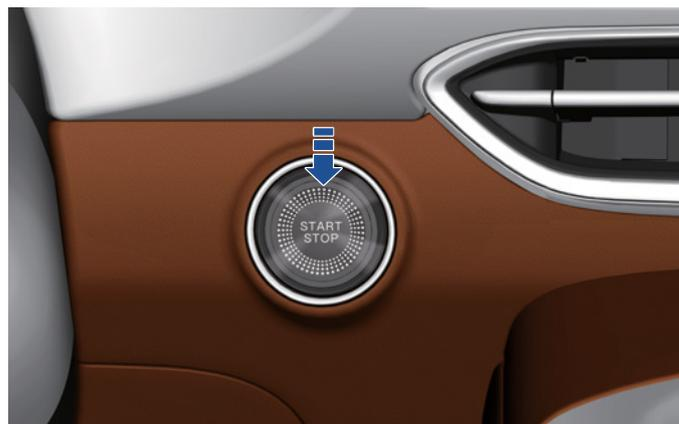
Das Fahrzeug ist mit einer START / STOPP-Taste ausgestattet. Die START / STOPP-Taste kann nur aktiviert werden, wenn das Fahrzeug den Schlüssel identifiziert.
