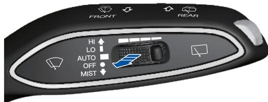
Ziehen Sie den Wischerhebel in Richtung Fahrer bis zur Endposition, die Frontdüse beginnt, Waschflüssigkeit zu versprühen und der Frontwischer arbeitet gleichzeitig.
