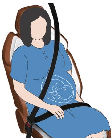
Wenn eine schwangere Frau einen Sicherheitsgurt trägt, sollte der Schultergurt reibungslos über die Brust verlaufen, der Gurt sollte möglichst tief über der Hüfte liegen und der Sicherheitsgurt sollte flach und fest anliegen. Der Sicherheitsgurt darf nicht auf dem Bauch liegen.
