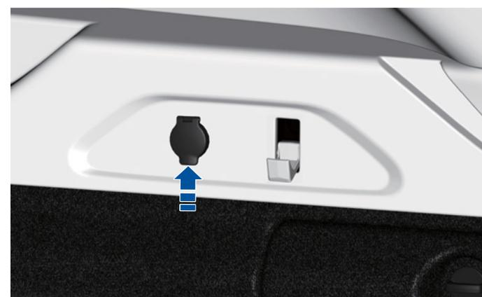
Die hintere 12-V-Steckdose befindet sich auf der rechten Seite des hinteren Gepäckraums und kann bei geöffneter Abdeckung genutzt werden. Die maximal zulässige Leistung beträgt 120 W.
