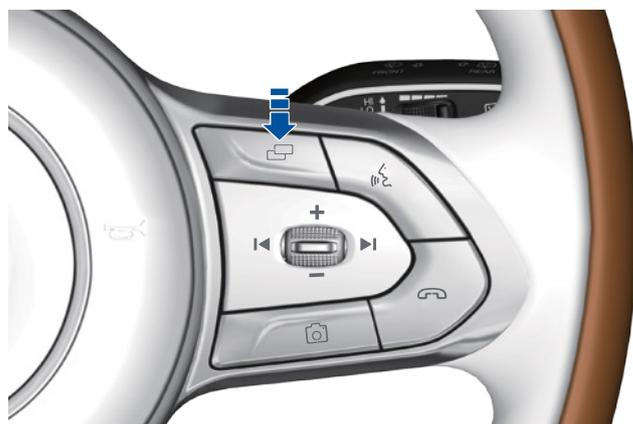
Die Informationen auf dem Fahrerdisplay können über die Menü-Taste am Lenkrad geändert werden, um den aktuellen Druck und die Temperatur der Fahrzeugreifen anzuzeigen.
