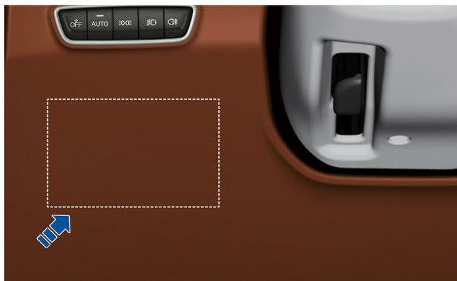
1. Entfernen Sie die Verkleidung auf der linken Seite des Lenkrads.
