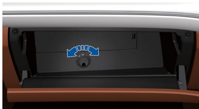
Der Handschuhfach-Belüftungsschalter befindet sich im Handschuhfach.
