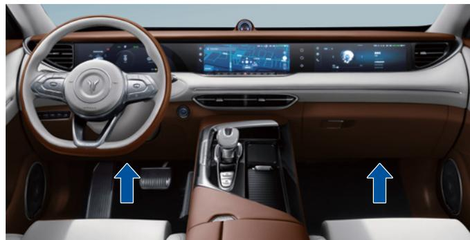
Vor dem Fahrer und vor dem Beifahrer sind Fussraumleuchten installiert, die beim Ein- und Aussteigen des Fahrzeugs für die Beleuchtung des Fahrgastbereichs in der ersten Reihe sorgen.
