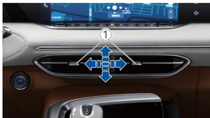
Bewegen Sie das Gitter nach oben, unten, links und rechts, um die Luftauslassrichtung anzupassen, und bewegen Sie es nach links/rechts, um den Luftauslass zu schliessen.
