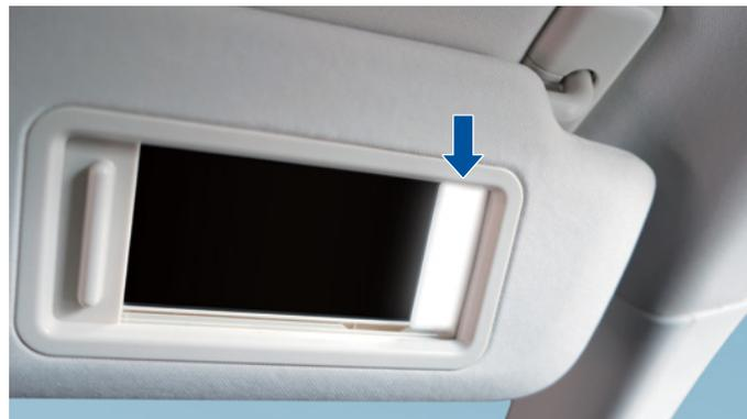
Klappen Sie die Sonnenblende herunter und öffnen Sie die Spiegelabdeckung. Das Make-up-Licht im Spiegel schaltet sich automatisch ein. Schliessen Sie die Abdeckung und das Make-up-Licht im Spiegel schaltet sich automatisch aus.
