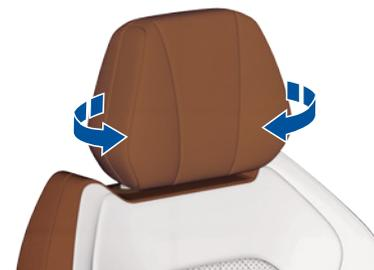
An den Kopfstützen der Vordersitze sind die Seiten verstellbar. Verstellen Sie die Flügel auf beiden Seiten manuell nach innen und aussen.
