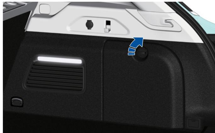
Drehen Sie den Abdeckplattenknopf um 90° im Uhrzeigersinn, um den Deckel zu öffnen, oder um 90° gegen den Uhrzeigersinn, um den Deckel zu schliessen.
