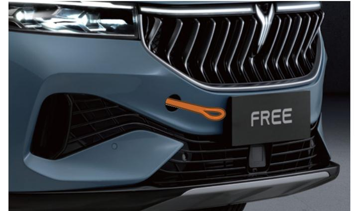
4. Verbinden Sie die Abschleppöse. Es wird empfohlen, ein Abschleppseil zu verwenden, das für das Abschleppen von Fahrzeugen bestimmt ist.
