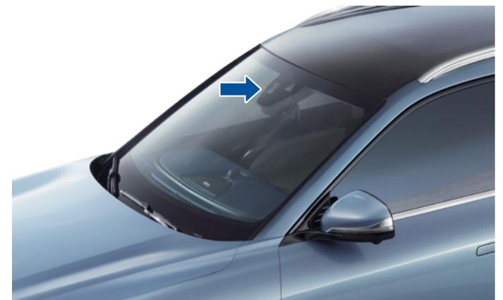
Die Position des Regen- und Lichtsensors wird durch den Pfeil in der Abbildung oben angezeigt. Wenn der Regen- und Lichtsensor Regen erkennt, schliessen sich die Fenster automatisch.
