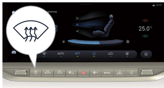
Drücken Sie die Taste für die Scheibenheizung, die Tastenanzeige leuchtet auf, die Scheibenheizungsfunktion wird aktiviert und das System führt automatisch die folgenden Einstellungen durch:
