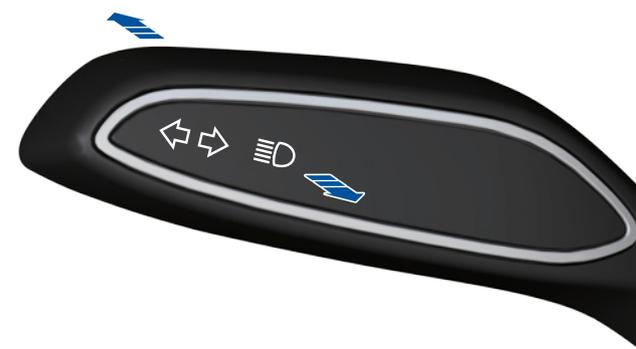
Wenn das Abblendlicht eingeschaltet ist, drücken Sie den Blinkerhebel in Richtung Armaturenbrett, um das Fernlicht einzuschalten. Die Fernlichtanzeige auf dem Fahrerdisplay leuchtet auf.
