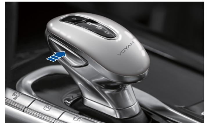
Wenn Sie die Stufen von P oder R ausgehend schalten, drücken Sie die Entriegelungstaste auf der Seite des Wahlhebels (wie durch den Pfeil in der Abbildung oben dargestellt).
