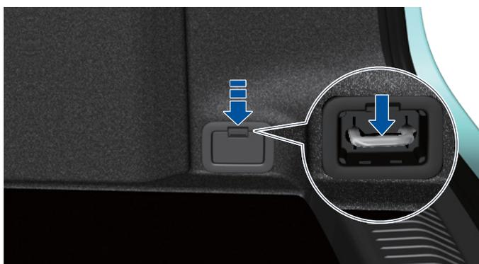
Drücken Sie die Abdeckung mit dem Finger in die durch den Pfeil im Bild oben angezeigte Richtung. Sobald die Abdeckung entriegelt ist, öffnen Sie die Abdeckung und verwenden Sie den Befestigungshaken.
