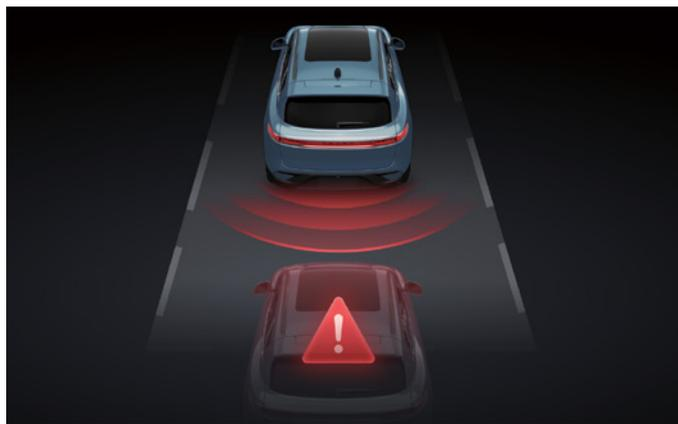
Die Auffahrwarnung (RCW) erfasst den Abstand zwischen Ihnen und dem Fahrzeug dahinter mittels Radar. Wenn sich das hinterherfahrende Fahrzeug schnell nähert und die Gefahr einer Kollision von hinten besteht, gibt die RCW ein Warnsignal aus und auf dem Fahrerbildschirm erscheint eine Warnung, um den Fahrer daran zu erinnern, dass ein Auffahrunfall auftreten kann. Gleichzeitig blinken die Blinkleuchten schnell, um die Fahrzeuge dahinter zu warnen, um einen Sicherheitsabstand einzuhalten.
