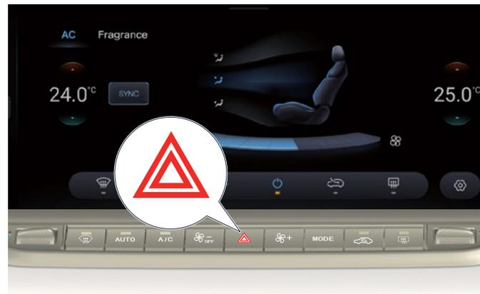
Der Warnblinkschalter befindet sich in der Mitte des Bedienfelds der Klimaanlage.
