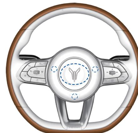
Drücken Sie auf die Position innerhalb des gepunkteten Bereichs am Lenkrad im Bild oben, die Hupe ertönt; lassen Sie sie los, um den Ton zu stoppen.
