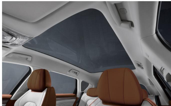
Das Panorama-Glasdach kann den Innenraum ausleuchten, verfügt aber auch über Wärmedämmung und UV-Schutz.
