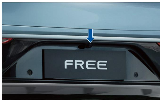
Die hintere Kennzeichenleuchte befindet sich neben der Rückfahrkamera und beleuchtet das Kennzeichen des Fahrzeugs.
