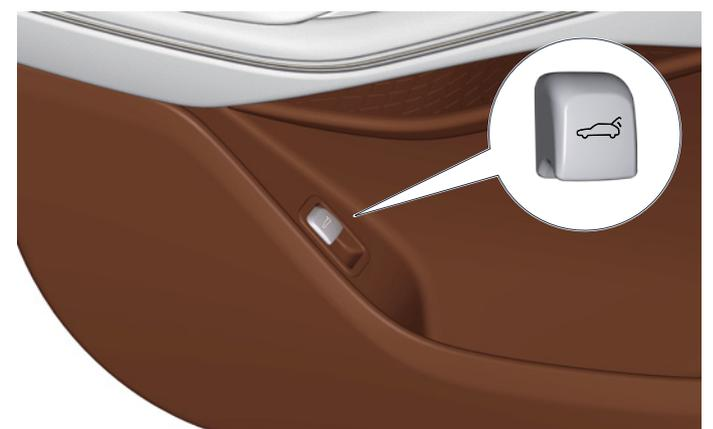
Ziehen Sie, bei stehendem Fahrzeug, den Heckklappenschalter auf der Fahrerseite hoch, um die Heckklappe zu öffnen. Drücken Sie die Heckklappentaste auf der Fahrerseite und die Heckklappe schliesst sich.
