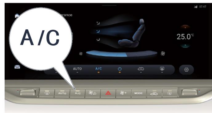
Drücken Sie die Klimaanlage-Taste, die Tastenanzeige leuchtet auf, die Klimaanlage aktiviert die Kühlfunktion.
