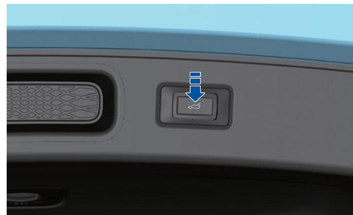
Drücken Sie auf der Unterseite der Heckklappe die Heckklappenverriegelungstaste, um die Heckklappe zu schliessen. Um die Öffnungshöhe der Heckklappe einzustellen, halten Sie die Taste in der gewünschten Höhe gedrückt. In diesem Fall ertönt ein langer Ton, der anzeigt, dass die Einstellung erfolgreich war.
