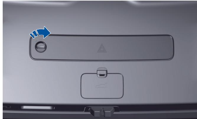
Das Warndreieck befindet sich innerhalb der Heckklappe. Öffnen Sie die Heckklappe, drehen Sie den Drehknopf der Abdeckplatte im Uhrzeigersinn, wie in der Abbildung oben gezeigt, öffnen Sie die Abdeckung und entfernen Sie das Warndreieck.
