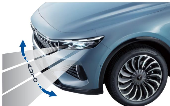
Das AFS-System passt den Lichtstrahlwinkel automatisch an den Beladungszustand des Fahrzeugs an (keine Beladung, leichte Beladung, mittlere Beladung, volle Beladung), um einen geeigneten Beleuchtungsbereich bereitzustellen.
