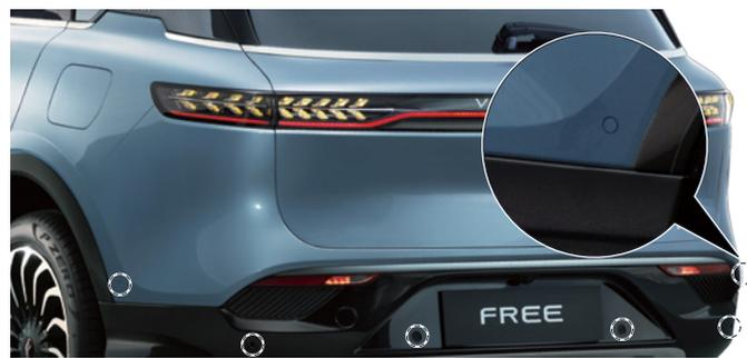
Die hinteren Parksensoren sind an der hinteren Stossstange des Fahrzeugs montiert.
