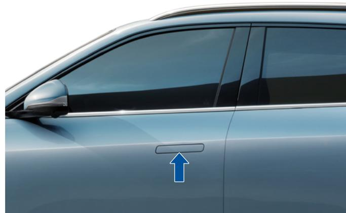
Das Fahrzeug ist mit verdeckten Griffen ausgestattet, um den Luftwiderstand zu reduzieren und ein besseres Fahrerlebnis zu bieten.
