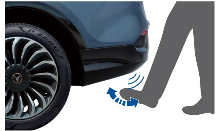
Begeben Sie sich mit dem Smart Key in den Erkennungsbereich des Fahrzeuges, bewegen Sie den Fuss mindestens 10 cm unter die Mitte des hinteren Stoßfängers und die Heckklappe öffnet / schliesst sich.
