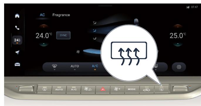
Drücken Sie die Heiztaste für Heckscheibe/ Aussenspiegel. Die Kontrollleuchte leuchtet auf und die Heizfunktion der Aussenspiegel ist eingeschaltet. Sie können Beschlag und Eis von den Aussenspiegeln und der Heckscheibe entfernen. Drücken Sie die Taste erneut, um die Heizfunktion zu deaktivieren.
