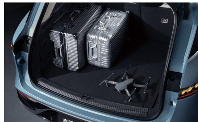
Im hinteren Gepäckraum können Sie grössere Gegenstände verstauen. Um eine stabile und sichere Fahrt des Fahrzeugs zu gewährleisten, sollten die Gepäckstücke möglichst gleichmässig verteilt werden und schwere Gegenstände im vorderen Teil des Gepäckraums untergebracht werden.
