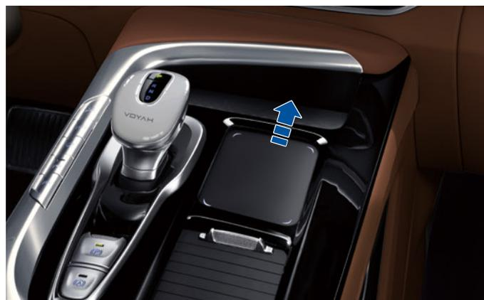
Der Induktionsbereich zum kabellosen Laden des Mobiltelefons befindet sich an der Vorderseite des Armaturenbretts (siehe Pfeil im Bild oben). Im App-Menü des Steuerungsbildschirms » wischen Sie einmal nach links, um die App "Settings" zu finden. Oder drücken Sie das Einstellungssymbol zwischen dem Steuerbildschirm und dem Beifahrerbildschirm. Wählen Sie dann im Menü "Device" aus und schalten Sie "Wireless charging for mobile devices" ein/aus.
