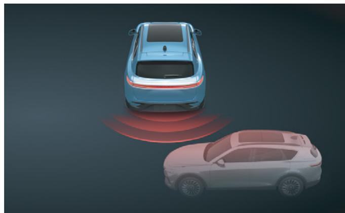
Befindet sich das Fahrzeug in Stufe R (Rückwärtsgang), erkennt die RCTA durch das Radar, wenn sich Fussgänger, Fahrzeuge oder sich bewegende Objekte der linken und rechten Seite des Hecks des Fahrzeugs nähern. Im Falle einer Kollision gibt das Fahrerdisplay eine Alarmmeldung aus, die von einem Warnton begleitet wird, um den Fahrer auf ein Hindernis aufmerksam zu machen und Unfälle zu vermeiden.
