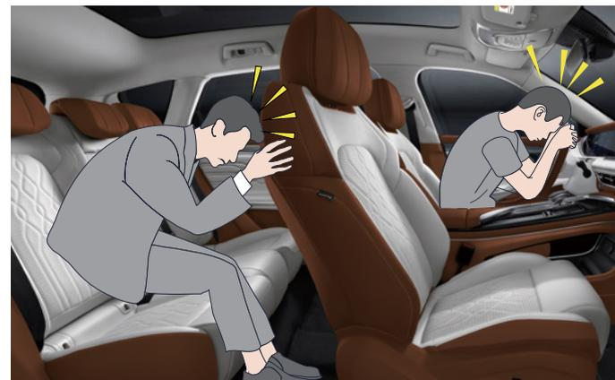
Bei einer Fahrzeugkollision können Fahrer und nicht angeschnallte Passagiere aufgrund der Massenträgheit aus dem Fahrzeug geschleudert und dadurch verletzt werden. Obwohl die Geschwindigkeit des Fahrzeugs sehr niedrig ist, ist die Kraft, die bei der Kollision auf den menschlichen Körper einwirkt, sehr gross, sodass es sehr wahrscheinlich zu einer Folgekollision / Verletzung kommt.
