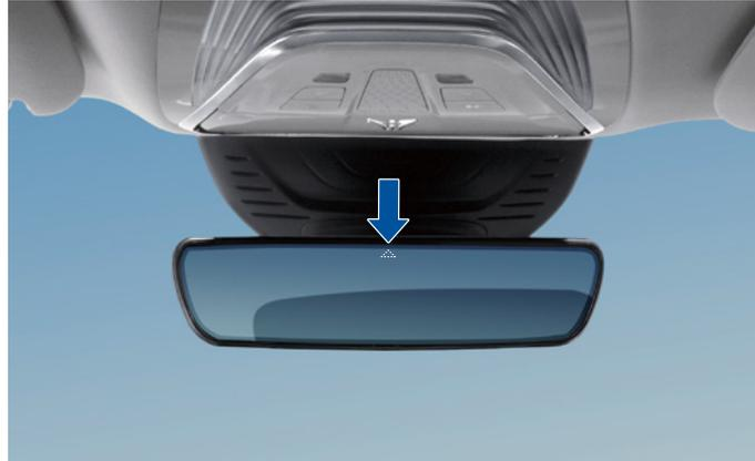
Das Fahrzeug ist mit einem automatischen Innenrückspiegel ausgestattet, der Blendungen verhindert. Wenn bei Dunkelheit helles Licht auf die Spiegelfläche einfällt, blendet der Innenrückspiegel automatisch ab, um die helle Reflexion des Lichts zu reduzieren.
