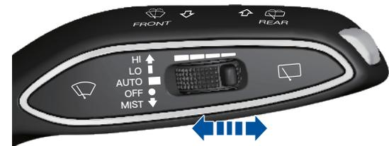
Wenn sich der Wischerhebel in der AUTO-Position befindet, drehen Sie den Regler nach links, um die Empfindlichkeit des automatischen Scheibenwischers zu erhöhen. Drehen Sie den Regler nach rechts, um die Empfindlichkeit zu verringern.
