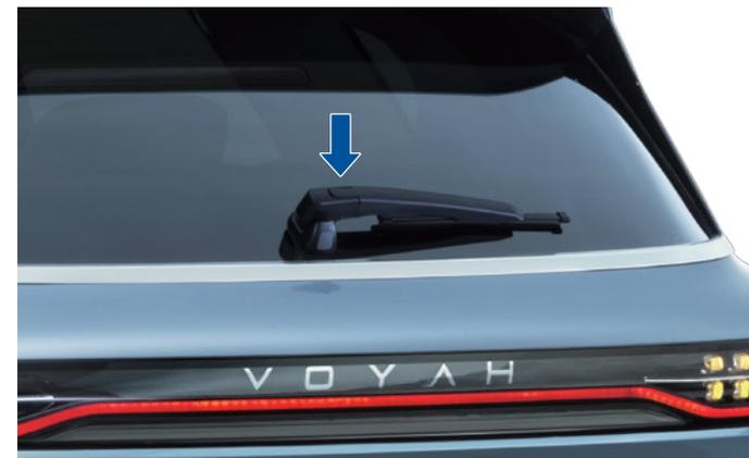
1. Heben Sie den hinteren Wischerarm an und wischen Sie Staub und Schmutz auf dem hinteren Wischerblatt mit einem weichen Tuch ab.
