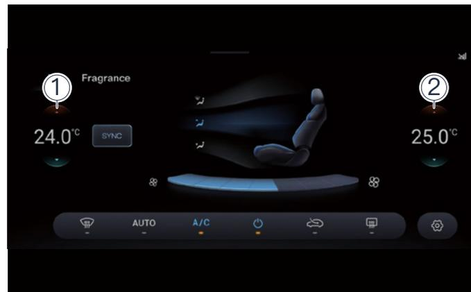
Im Zwei-Zonen-Regelmodus kann die Temperatur im Fahrerbereich und im Beifahrerbereich getrennt eingestellt werden:
