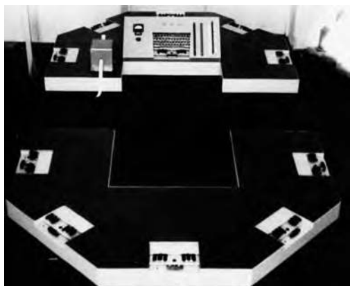
Телетактор — электронное устройство, позволяющее передавать вводимый текст в виде рельефно-точечного шрифта Брайля. Использовалось для организации одновременного общения нескольких слепоглохих или зрячеслышащих людей. Фото из архива А.И. Мещерякова.
