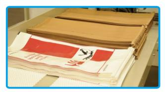
Sewn Paper Sack atau lebih dikenal dengan sebutan karung kertas jahit merupakan karung kertas dengan dengan jahitan pada bagian bawahnya. Karung kertas ini dapat diberi plastik pada bagian dalam karung atau disisipkan pada lapisan layer karung kertas.
