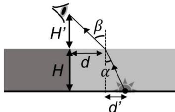
Para obtener  $d'$ , necesitamos calcular el ángulo de incidencia  $\alpha$  utilizando la Ley de Snell. Primero, calculamos el ángulo de refracción  $\beta$ :
