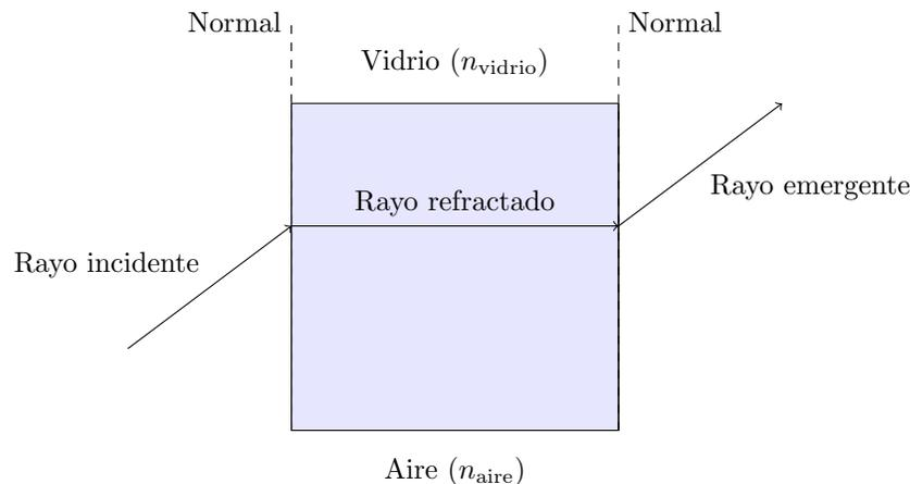
Por lo tanto, el esquema muestra la trayectoria del rayo incidente, refractado y emergente con los ángulos correspondientes.
