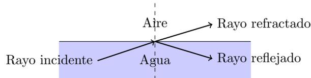
Vemos en el esquema que  $\theta_{\text{refl}} + 128^\circ + \theta_{\text{refl}} = 180^\circ$ , por lo que  $\theta_{\text{refl}} = 22^\circ$ .
