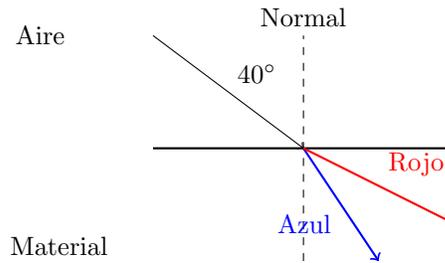
En el aire, ambos rayos inciden con un ángulo de  $40^\circ$  respecto a la normal. Al entrar en el material, debido a la mayor densidad óptica, se produce refracción. Según la Ley de Snell:
