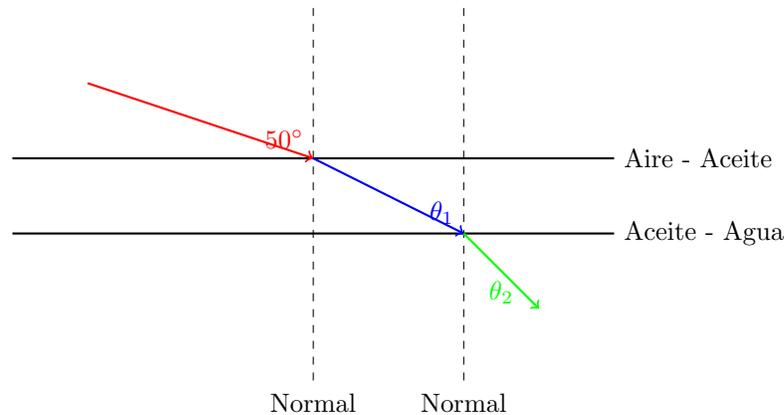
En el diagrama se muestra el rayo de luz incidente desde el aire hacia la capa de aceite, formando un ángulo de  $50^\circ$  con la normal. Al entrar en el aceite, el rayo se refracta formando un ángulo  $\theta_1$  con la normal, y al pasar al agua, se refracta nuevamente formando un ángulo  $\theta_2$ .
