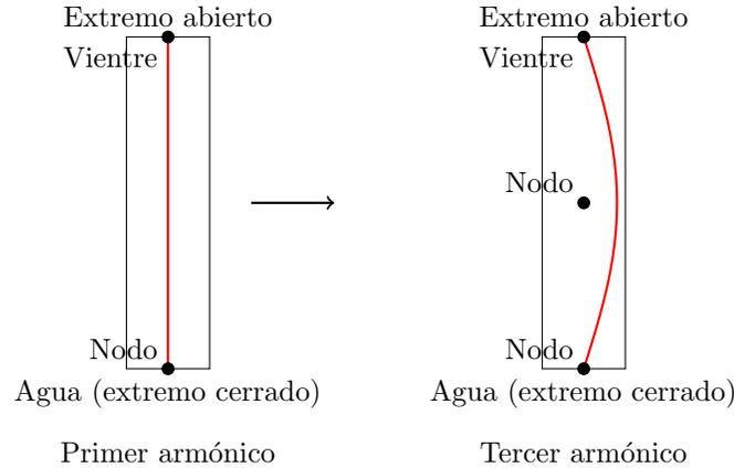
En ambos casos, hay un *nodo* en el extremo cerrado (agua) y un *vientre* en el extremo abierto. En la segunda resonancia (tercer armónico), aparece un nodo adicional en el centro del tubo. La longitud de onda  $\lambda$  del sonido en el aire depende de la frecuencia y de la velocidad del sonido en el aire:
