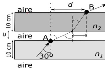
Nótese que los ángulos señalados entre los dos cristales en la figura anterior son todos iguales y serán denotados como  $\theta$ , mientras que el ángulo en la cara interna del segundo cristal es  $\theta'$ . Por otra parte, la distancia horizontal recorrida por el rayo de luz en el segundo medio es  $d'$ .
