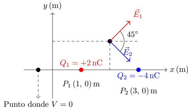
Para determinar el campo eléctrico en el punto (2, 1) m debido a las cargas  $Q_1$  y  $Q_2$ , observamos que los vectores de campo eléctrico  $\vec{E}_1$  y  $\vec{E}_2$  forman un ángulo de  $45^\circ$  con respecto al eje  $x$ , como se muestra en la figura. Primero, calculamos la distancia desde cada carga hasta el punto de interés utilizando el Teorema de Pitágoras:
