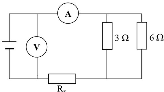
Umieszczony w tym obwodzie amperomierz pokazuje natężenie prądu równe 3 A, a woltomierz napięcie 15 V.
