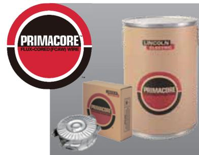
**PRIMACORE™ LW-70MC** は、490N/mm<sup>2</sup> 級炭素鋼の下 / 横向き姿勢用炭酸ガスアーク溶接用メタルコアドワイヤです。溶着速度が高く高能率で、高速溶接にも適しています。良好なビード外観、低スパッタ、そして優れた機械的性質が得られるとともにプライマ塗装またはミルスケールの付いた鋼板に対しても良好な耐ブローホール性を有するコストパフォーマンスの優れたワイヤです。
