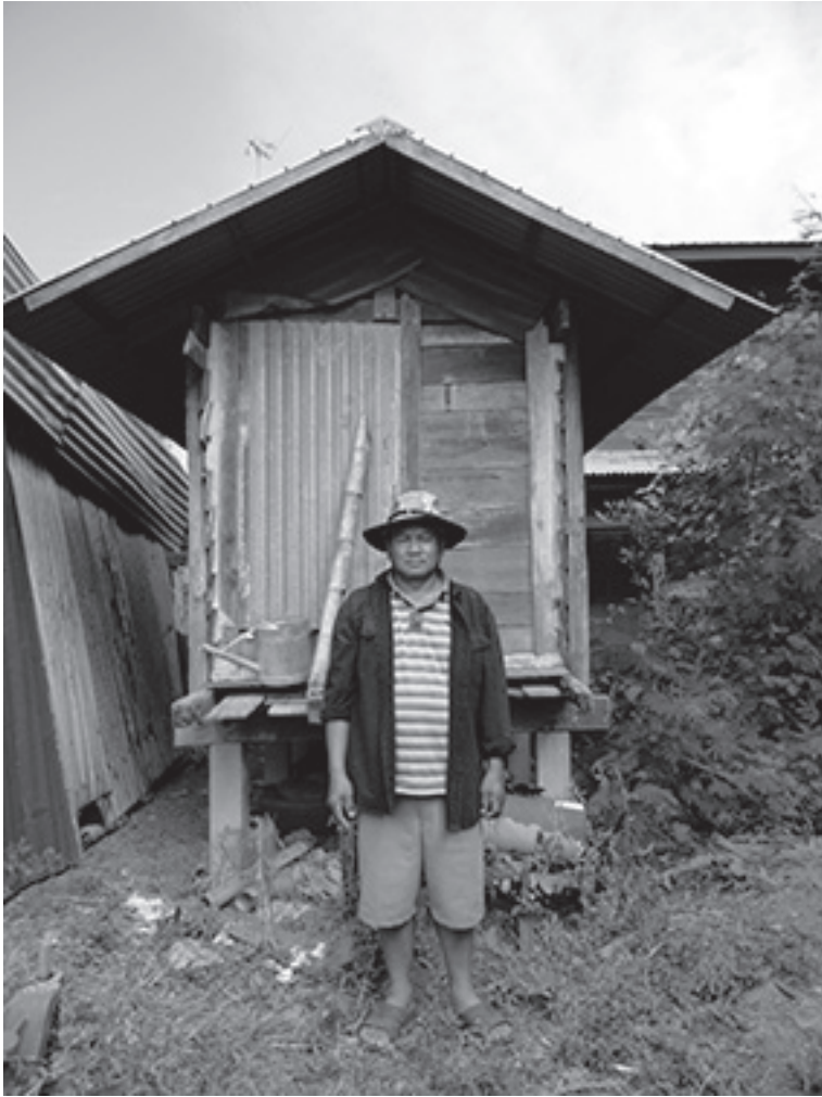
ภาพที่ ๓ ภาพเต้าข้าวของนายบุญเรือน ชาวเกียน อายุ ๕๘ ปี ชาวบ้านคำแสน หมู่ ๑๑ ตำบลชุมช้าง อำเภอโพธิ์ชัย จังหวัดหนองคาย สัดส่วนยกพื้นสูง ๐.๘ เมตร ความกว้าง ๑.๕ เมตร ความสูง ๒ เมตร ความยาว ๓ เมตร ขานยื่นออกจากตัวเต้า ๐.๕ เมตร หลังคาจั่วสองด้านเท่ากัน ชายคายื่นออกมา ๐.๖ เมตร, ภาพโดย : นางสาววรรณฤดี โลกธาตุ วันที่ ๒๕ ธันวาคม ๒๕๕๙.
