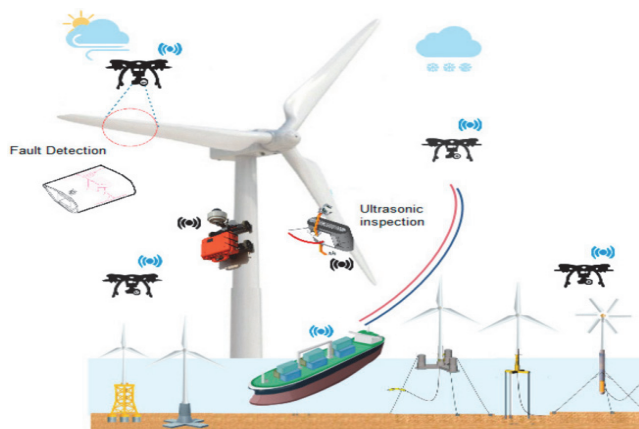
Слика 4: Инспекција ветрогенератора помоћу дрона
