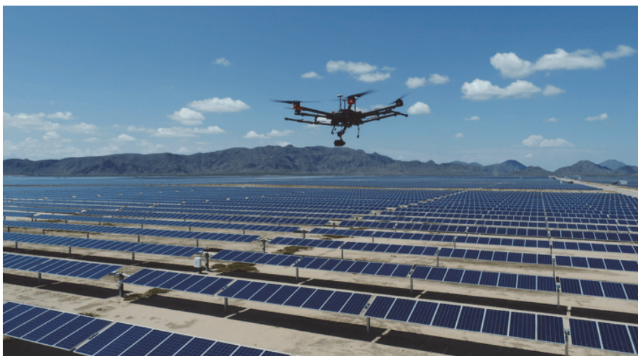
Слика 5: Инспекција соларних фарми употребом дрона
