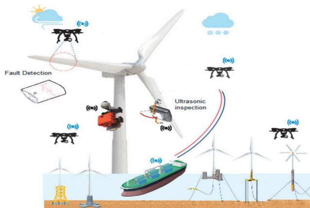
Слика 4: Инспекција ветрогенератора помоћу дрoнова
