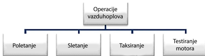
Slika 3.2. Izvori vazduhoplovne buke na i oko aerodroma u zavisnosti od operacije vazduhoplova, Izvor [2]
