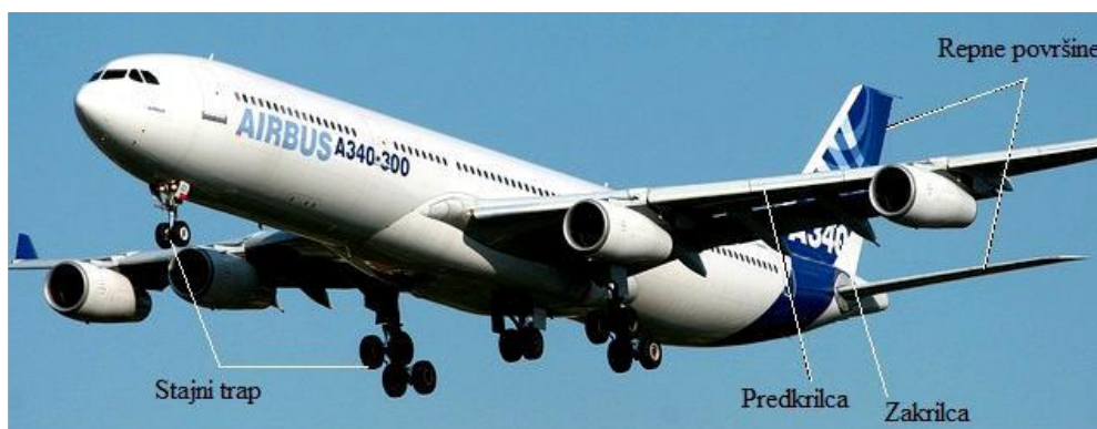
Slika 3.4. Izvor buke strukture vazduhoplova
