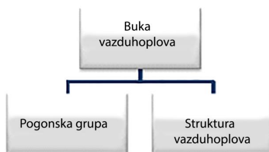
Slika 3.3. Izvor buke na vazduhoplovu, Izvor: [2]
